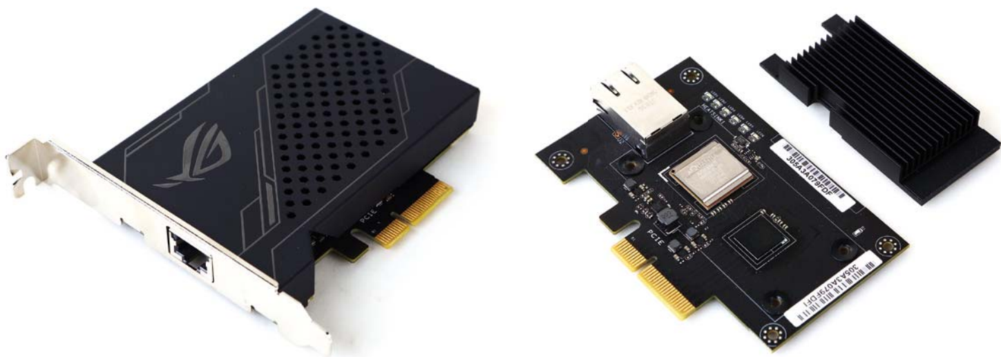
■ 这款万兆网卡的核心是采用了Aquantia AQ105，一款由19nm工艺打造的万兆PHY芯片，为了保证稳定运行，华硕还专门为它配备了散热片。
