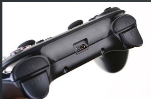
■ L1和R1键采用了导电胶设计，而L2和R2键的采用了线性压感的组合联动模块结构，手感不错。
