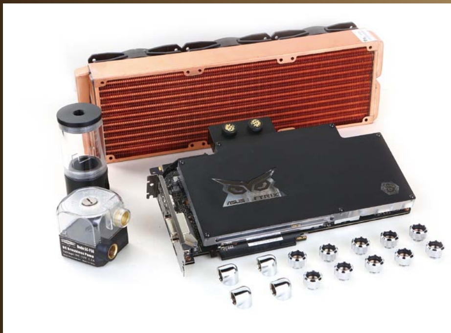
■ 临时搭建的水冷系统,只包含水泵-显卡-冷排-水箱-水泵的简单循环。其中水泵是国产型号,阻抗能力只有DDC 10W一半左右,冷排则是“水手”中口碑不错的科瑞沃的喀秋莎系列360纯铜厚排,搭配了3个智能控速1225风扇。
