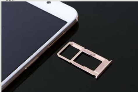
>> 二合一卡槽也采用了铝合金一体成型工艺,精致且坚固。
