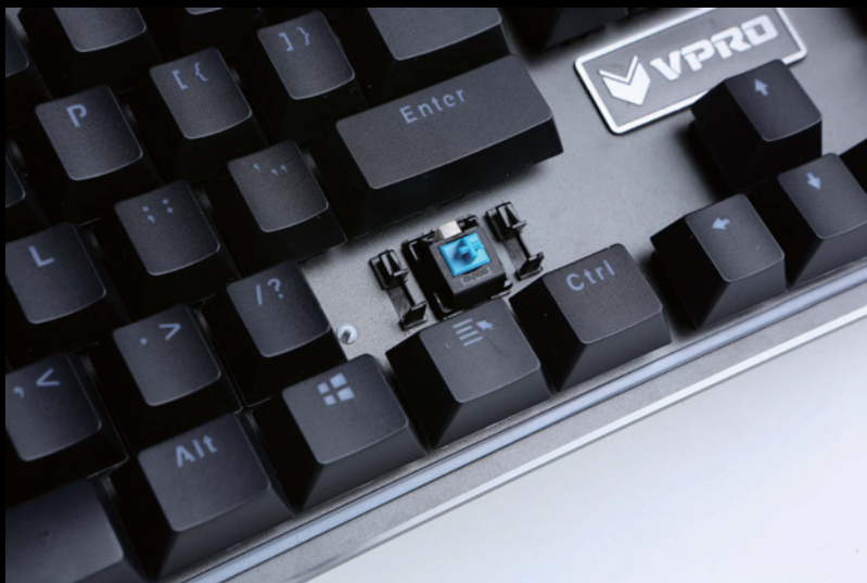
■ 雷柏V720 RGB大键位的平衡杆设计独特，但也为更换个性键帽带来了小麻烦。
