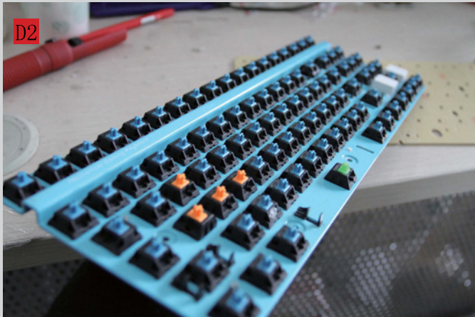
D2 将全部或想要添加背光效果的键位的轴安装在钢板上，注意此时不需要将轴体穿过PCB上的键轴安装孔，穿过钢板即可。
