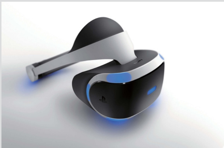
■ 当前上市的初代商业化VR设备之一——索尼PlayStation VR，其分辨率双眼合起来1920×1080和主流显示器持平，可视角度为100度，延迟为18ms，优势是和自己的主机平台完美契合，配合度良好。
