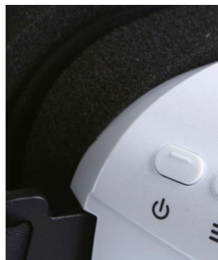
■ 触控板上方是3Glasses D2开拓者版的两个按键: 开关和菜单键。长按开关机即可实现开关; 在播放时长按菜单键即可退出。
