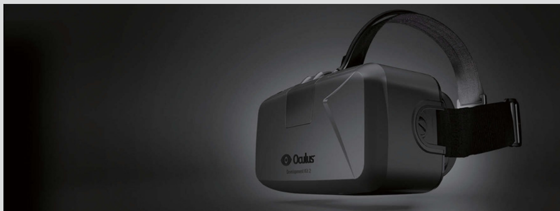
■ 当前上市的初代商业化VR设备之一——Oculus Rift DK2,其单眼分辨率960×1080,镜内显示屏尺寸5.7英寸,使用了AMOLED屏,据说延迟低至2~3ms。
