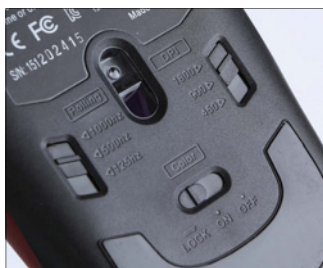
>> IM6幻彩翼游戏鼠标的底部拥有三个可分别调节鼠标背光、回报率、CPI的按钮。
