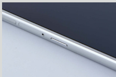
>> 机身左侧设有独立的拍照键,不过似乎不能在待机状态下直接启动相机拍照。
