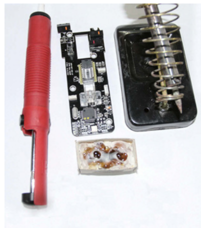
■ 步骤一：我们需要用到的工具以及拆下来的赛睿橙点微动
