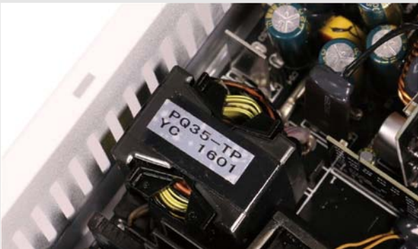
■ 传统变压器的夹层式结构,原边夹副边的结构比较明显。
