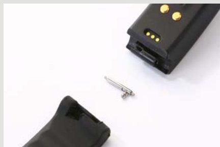
>> 腕带的拆卸较为简单，只需轻轻拨动金属杆即可卸下。
