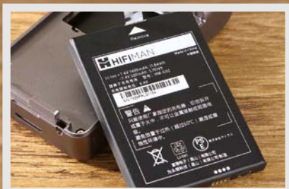
■ 1600mAh容量的电池和HIFIMAN旗下的HM901s、HM802U等播放器通用，依旧是采用7.4V高电压供电，续航能力不错。
