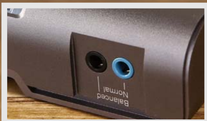
■ HM802s机身顶部提供了平衡插孔与单端插孔，用户可以直接根据所使用的耳机选择相应的接口。
