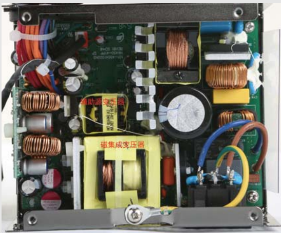
■ 磁集成的电源中没有谐振电感,所以可以做得更加紧凑。
