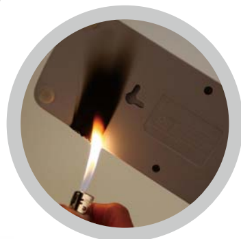
>> 用打火机对奥睿科WPC-4A的燃烧测试
