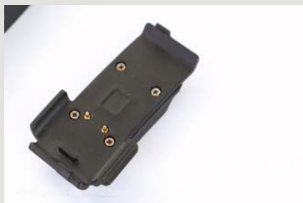
>> clingband的充电器为一个塑料卡扣，插上容易，拔出难。
