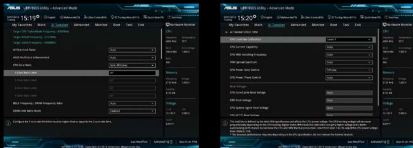
■ 华硕Z170主板BIOS界面与设置项目，防掉压数值最大可设置为LEVEL 7。
