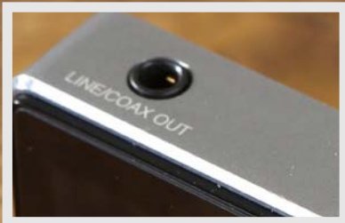
■ 顶部的设计最为简洁，只有一个3.5mm线路输出和同轴输出复合接口。
