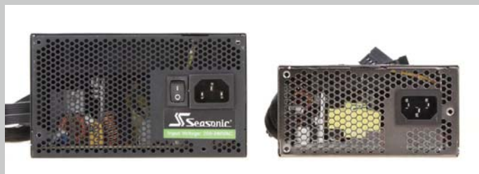
■ SFX(右)相比ATX的规格差距，体积瘦身明显。
