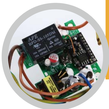
>> 搭配的继电器和WiFi模块, 同时采用了一体铜, 用料扎实。
