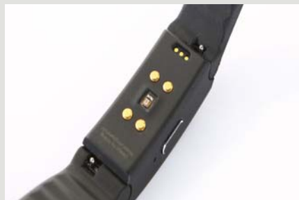
>> 机身背面搭载的传感器可以监测到用户的体温和心率
