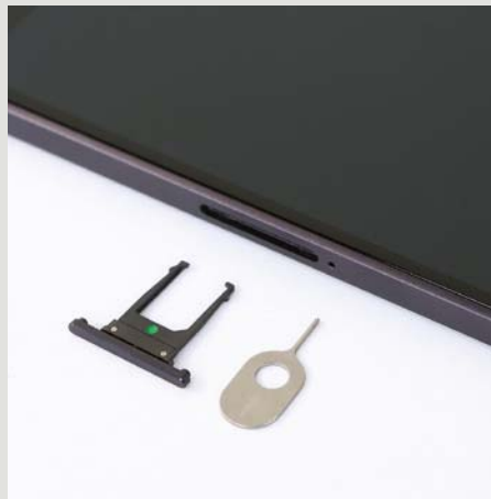
>> 机身右侧音量键集成了SIM卡托功能，和摩托罗拉Droid Turbo设计同出一辙。侧面按键触发力度大，触感偏硬，再加上长条形状，令手指很是痛苦。
