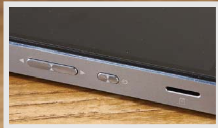
■ 机身左侧包括了音量调节键和电源开关，此外还有MicroSD卡槽方便用户扩展，卡槽开放式的设计可能会有积灰的困扰，如果能做成如手机般的卡托设计就完美了。
