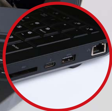
■ 机身上配备有较为丰富的接口，包括一个USB 3.1、三个USB 3.0（其中一个支持关机充电）、一个HDMI、一个有线网络接口、一个多合一读卡器、一组音频接口以及一个Alienware显卡扩展坞接口。
