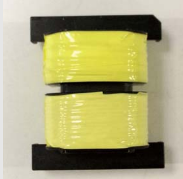
■ 磁集成的变压器线包,可以看见原副边是远远隔开的。
