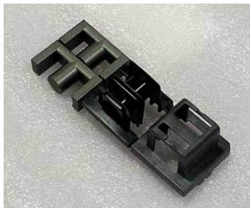
■ 磁集成变压器“组合套装”，两瓣磁芯，分槽骨架，以及线包护套。骨架往往是定制的，中间挡墙的位置与宽度确定下来后，其他参数都只能从别的地方去“凑”。而护套则完全是为了增加爬电距离，满足安规要求。
