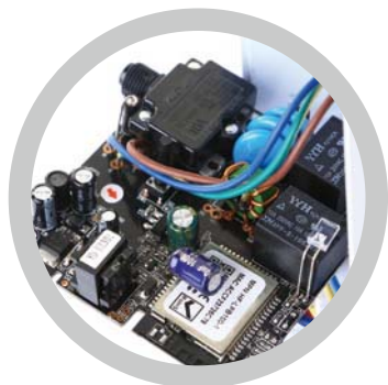
>> 硕大的PCB上分布着WiFi无线网卡、继电器、过载保护器等料件。
