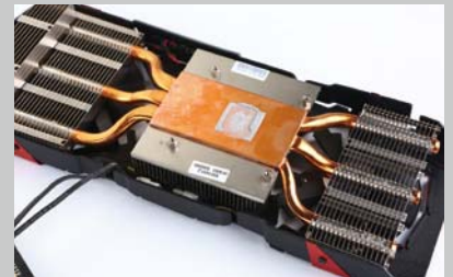
>> 纯铜的三根散热导管
