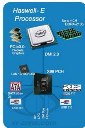
■ 从Intel 9系芯片组架构来看，即使在高端的X99平台上，其PCH都是内建的PCIe 2.0通道，而处理器内建PCIe 3.0通道用来支持显卡。
