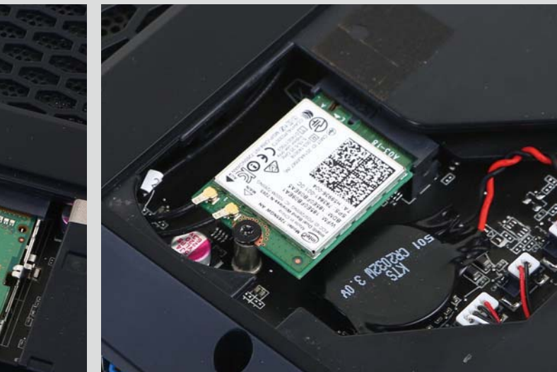
■ 英特尔Wireless N7265无线网卡，支持2.4GHz/5GHz双频带和802.11n协议。
