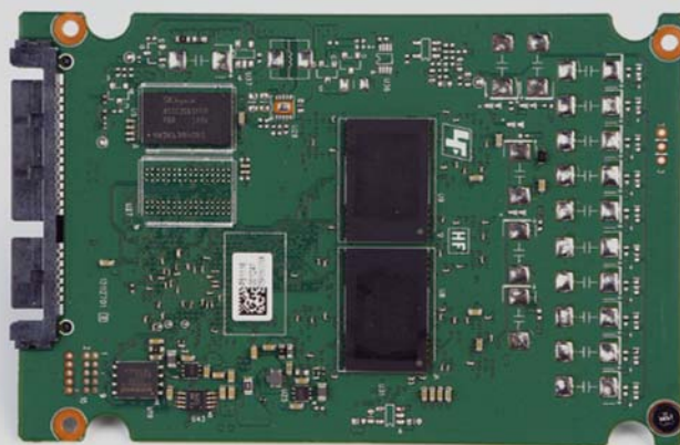
■ 睿速T9 128GB固态硬盘由8颗eMLC闪存颗粒、一颗256MB缓存、一颗Marvell 88SS9187主控芯片组成。
