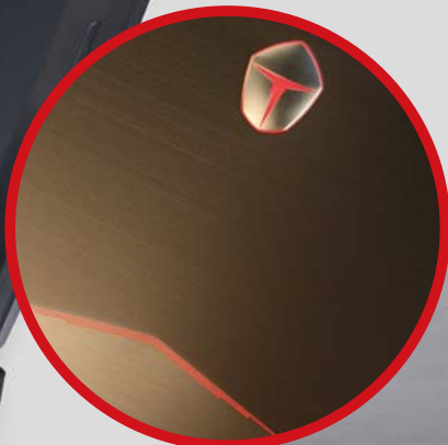
■ 标识性的网格灯效继续沿用，其采用了CNC精密镂空工艺，镁铝合金表面也采用了阳极氧化工艺处理，并且具有拉丝质感。
