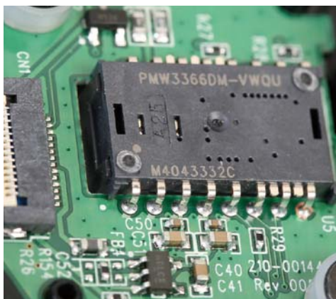
■ 罗技G502 RGB版游戏鼠标使用了原相的PMW3366DM芯片
