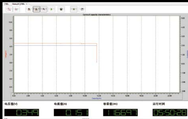
■ 在2A下,小米20000mAh的放电曲线出现了小幅波动。
