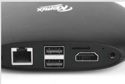
>> Remix Mini的背后有很多接口,从左到右依次是RJ-45、USB2.0×2、TF卡槽、HDMI 2.0接口和耳机孔。
