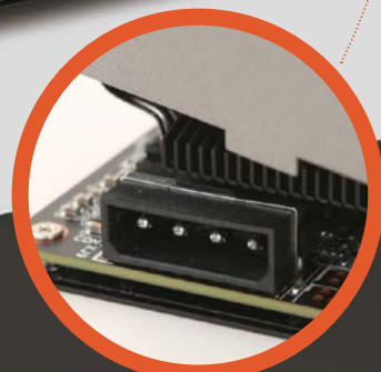
■ 该显卡提供给玩家的D形接口，带电压测量点
