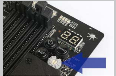
>> 板载电源按钮附近的智能超频旋钮(共9档,每档提升2倍频同时核心电压也会自动调整)
