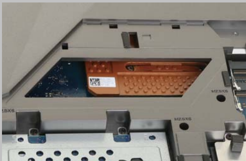
■ 在一个进风口下，可以看到GPU散热盖板上的小圆柱。
