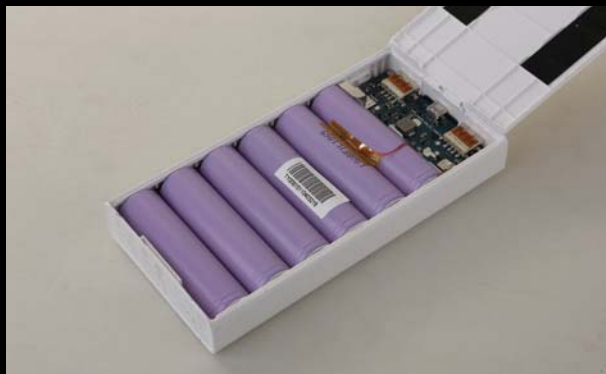
■ 20000mAh的内部搭配的是6节来自LG的18650电芯
