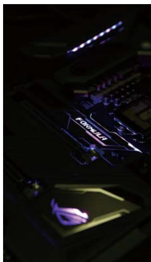
■ 完美支持 DDR4 3600内存, MAXIMUS VII FORMULA的双通道写入带宽突破53000MB/s, 内存延迟只有43ns, 为充分发挥出CPU性能提供了充足保障。
