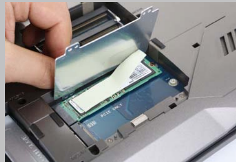
■ 在SSD上面覆盖了一块金属板，并利用导热胶传递热量。
