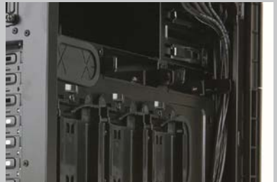
>> 背部在HDD和SSD满载的情况下，设计师依然预留有足够的通道走线
