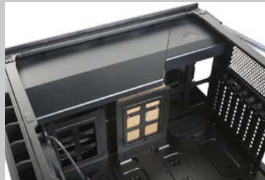
>> 顶部电源等设备的专用仓位
