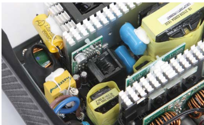
■ LLC谐振级上少见的双电容方案，组成没有漂移、高精度的电流互感器方案。
