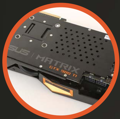
■ 具有拉丝质感的镂空背板，搭配有固定支架。
