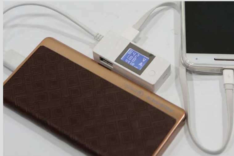
■ 在快充模式下，摩米士iPower ELITE+能提供8.42V/1.88A的电流电压。
