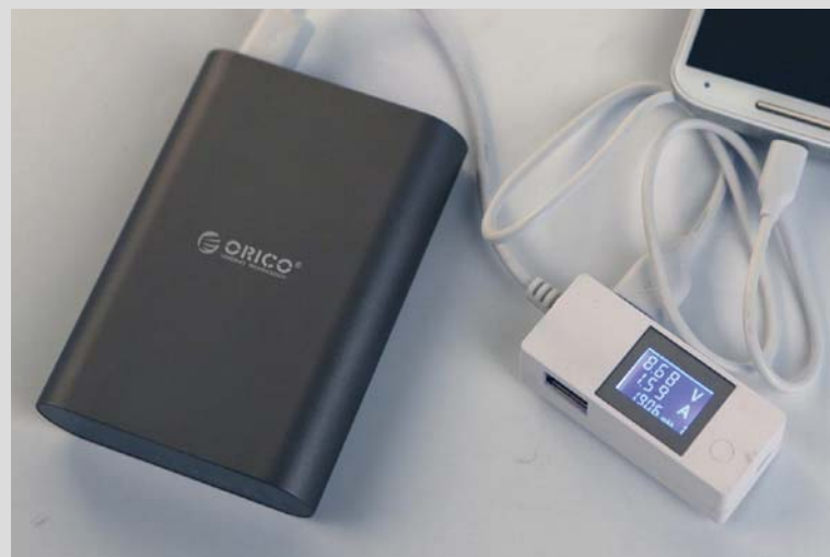
■ 在快充模式下，Q1能提供8.68V/1.59A的电流电压。
