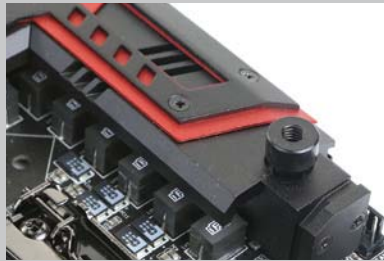
>> 处理器散热系统带有水冷接口
