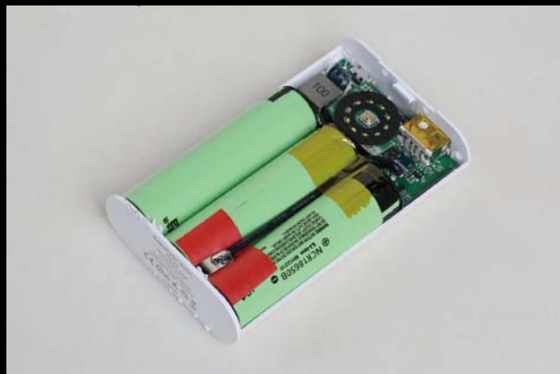
■ PowerCore+10050内部做工不错，搭配有防滚架。此外电芯也由之前的三洋更换为松下。
