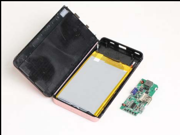
■ 其内部设计比较一般，没有防滚架之类的保护装置，直接是电芯+PCB，比较简单。
