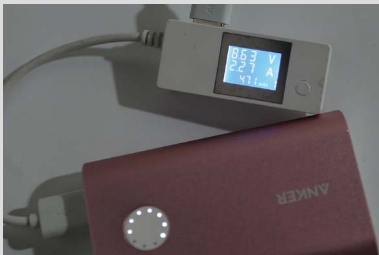
■ 在快充模式下，PowerCore+10050能提供8.63V/2.27A的电流电压。
