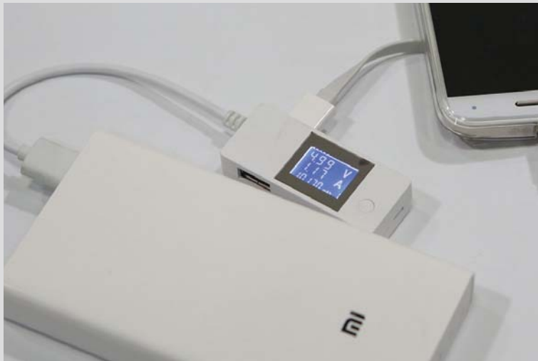
■ 小米的输出不支持快充，通过Moto X Style只能输出5V/1A左右的电压电流。
