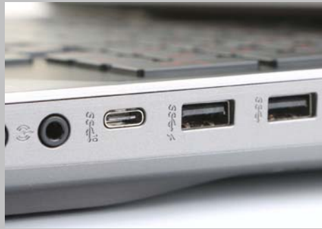
■ 右侧的三个USB接口功能更加丰富，其中一个USB Type-C接口兼容了USB 3.1和Thunderbolt 3标准，另一个USB 3.0接口则支持关机充电功能。
