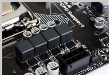
>> 由安森美低内阻MOSFET与钰邦固态电容组成的4相处理器供电系统
