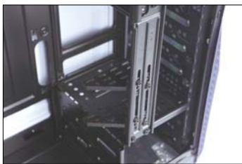
>> 航嘉MVP MINI II机箱内部设计有显卡支架, 给显卡提供了有效支撑。
