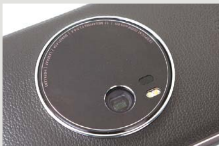
>> “奥利奥”大镜头旁是双色温补光灯,还支持激光辅助对焦,大大提升了拍照可玩性。
