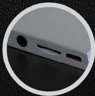
■ 接口区位于机身底部, 其中MicroSD卡槽最大可支持256GB存储卡扩展。
