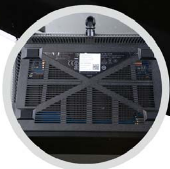
■ 底部散热口面积的增加使得机身整体散热性能得以提升
