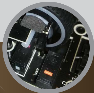
赛睿Rival 300暴怒野兽依旧采用了赛睿橙点微动,按键寿命高达3000万次。
