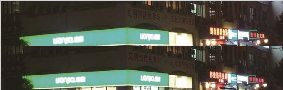
>> 在夜景不跑焦的情况下(中间墙上文字清晰), 由于小米Note 2的IMX318单位像素尺寸相比小米5s所搭载的IMX378稍小, 所以在进光量上有些劣势, 从远处的“草根”二字最终成像便可看出差别, 另外放大后可以注意到Note 2样片在右边灯箱广告牌边缘的涂抹感较重, 这也是两者在弱光环境下拍片的画质差异。(上: 小米5s, 下: 小米Note 2)
