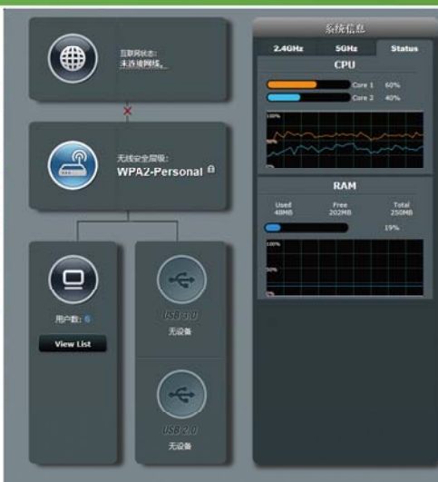
■ 负载测试中,两个CPU的利用率分别在60%、40%上下徘徊。
