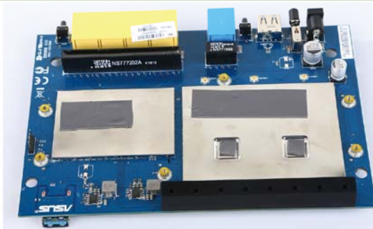
■ CPU和无线芯片也分别通过金属屏蔽罩进行封装处理
