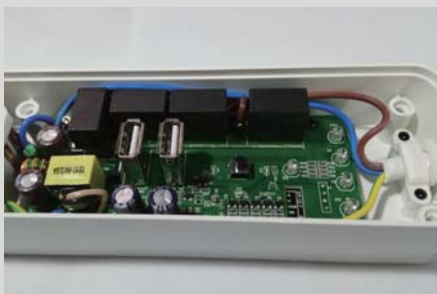
>>PCB 端配备有四个继电器，并搭配有电容和变压器等料件。
