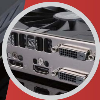
■ 视频输出接口配备了两个DVI接口、一个DP和一个HDMI接口, 基本上能满足大部分玩家的接口需求。
