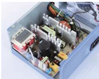
>> 内部做工不错，采用单管正激加磁放大器和二极管整流的结构。
