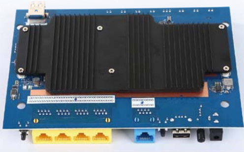
■ PCB板正反面都安装了大面积的散热片
