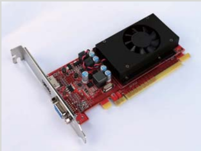
>>显卡插槽的存在也为兆芯台式机搭载独立显卡创造了条件,这款台式机采用了来自AMD的Radeon R5 340显卡,流处理单元数量达到384个,支持最新的DirectX 12 API,板载1GB GDDR5显存。
