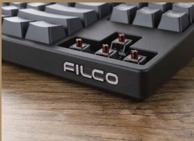
评测的这款87式圣手2双模机械键盘使用了Cherry MX茶轴, 熟悉的金属Logo印刻在下边框右侧。
