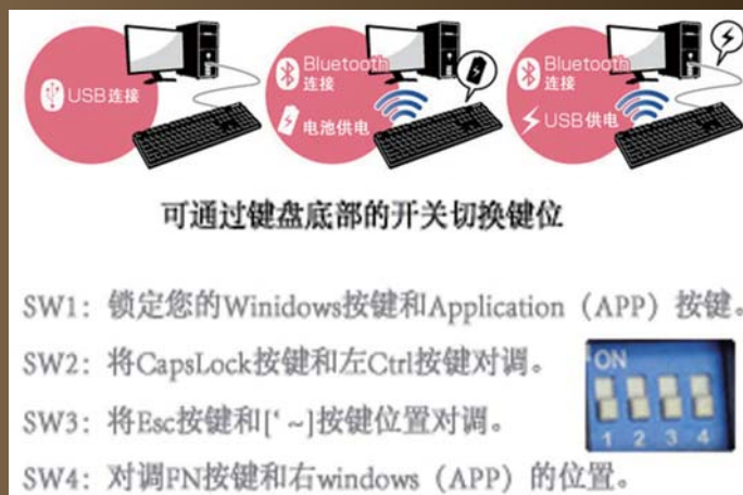
Majestouch Convertible 2与设备连接的三种方式示意图以及DIP开关四个按键功能介绍
