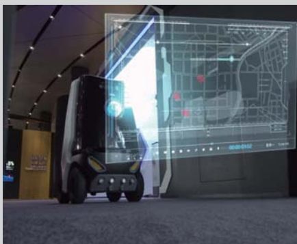
>> 无人送货机器人小 G 是由菜鸟 E.T. 物流实验室研发的末端配送机器人,为“快递最后一公里”而生,它拥有强大的独立思考能力和计算能力,不仅自己会上电梯、感知电梯的拥挤程度,还能识别路上的行人、车辆,智能规划路线。
