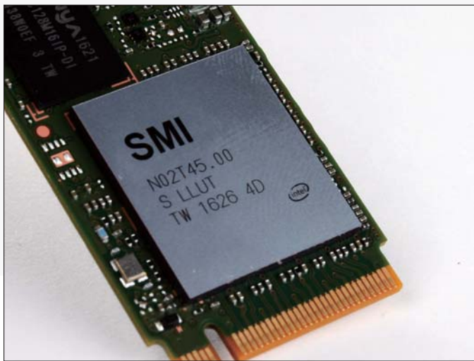
■ 采用了符合NVMe 1.1技术标准的SM2260 8通道主控芯片
