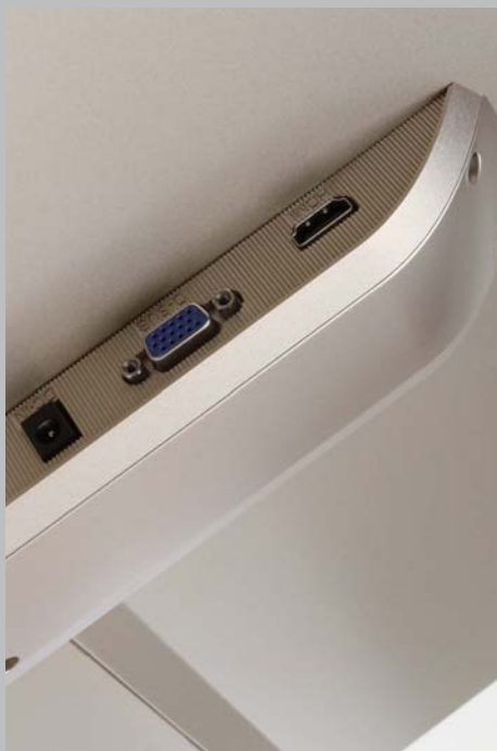
>> 采用HDMI+VGA的接口组合
