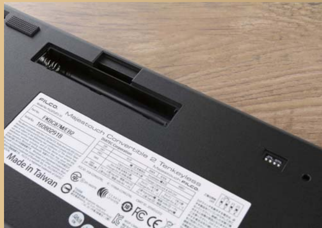
■ 背部设有电池槽与DIP开关,后者则可以调节多个的工作方式。
