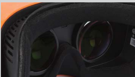
>> 两个3.81英寸AMOLED屏幕，单眼分辨率为1200×1080，102° FOV，支持防蓝光功能。
