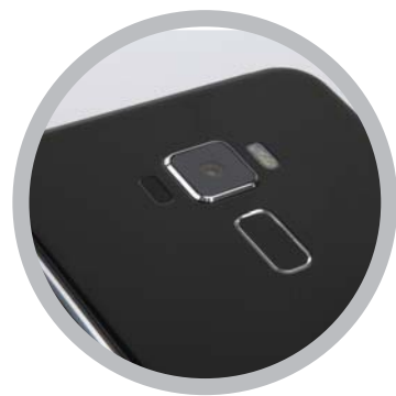
后置摄像头左、右、下方分别是激光对焦模块、双色温闪光灯和指纹识别键。
