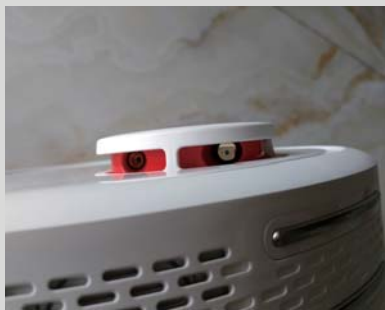
>> “大鼻子”里的激光测距传感器
