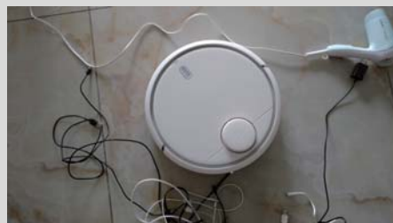
>> 遇到有电线的情况下，机器人一般能很快地通过，但是遇到诸如耳机线等细小线材的话会被缠绕
