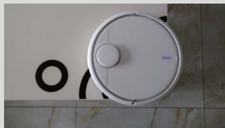
>> 机器人放在茶几上，底部的防跌落传感器会及时检测到附近的路况，清扫也较为干净
