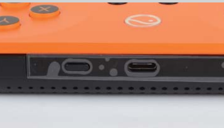
>> 另外一侧是充电接口，同样采用Type-C接口，支持QC快充功能；旁边是一个开关按钮（长按10秒以上为复位）和电量指示灯，采用四级LED电量显示。
