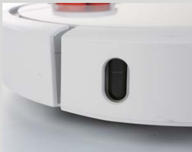
>> 扫地机器人中少见的沿墙传感器
