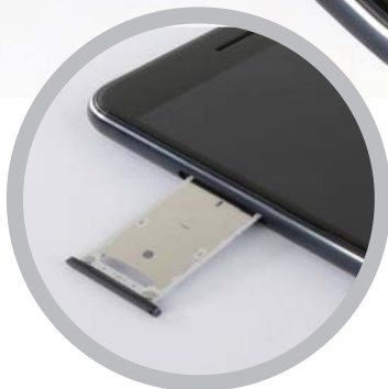
机身左侧为三选二SIM卡槽，支持一SIM卡+SD卡拓展或是双Nano SIM卡。
