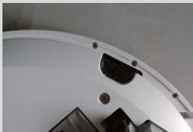
>> 米家扫地机器人底部的悬崖探测器
