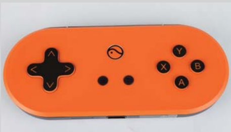
>> 手柄整体比成年人手掌略小，中间大的Logo按钮为Home键，作用与手机上的Home键一样；下面两个按键，一个是菜单键（短按打开系统菜单，长按为2D/VR模式切换）一个是返回键。左侧为方向键区，右侧为X/Y/A/B操作键区，在系统中A键为确认，B为返回功能。顶部左右两侧的L/R键，短按L为确认，R+上下方向可调节音量。
