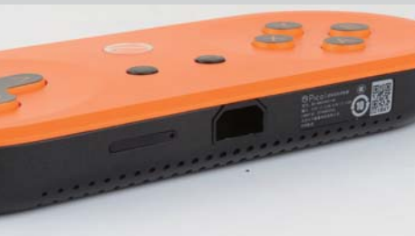
>> 手柄一侧的接口用于连接VR眼镜，采用Type-C接口，外形上采用了异形设计；旁边是一个MicroSD卡扩展插槽，最高可扩展128GB存储。
