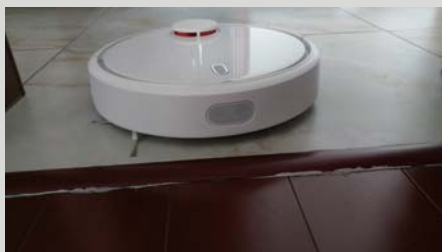
>> 一般来说，1cm 高的小障碍都能轻松突破，机器人会升高轮胎然后冲过去
