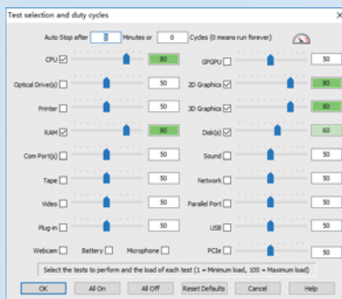
■ 烤机测试主要对CPU、2D图形核心、3D图形核心、内存、硬盘这五大子系统进行了测试。
