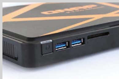
>> 正面一侧有两个USB 3.0接口，此外还有可以读取SD卡的卡槽以及备份键
