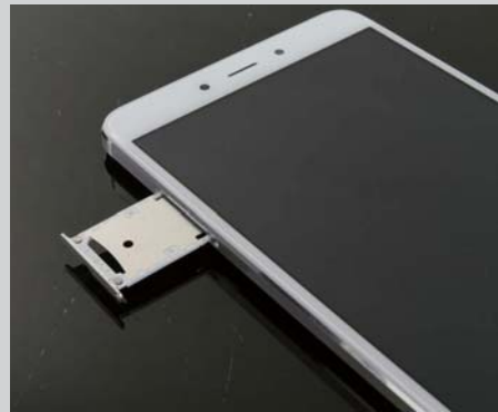
>> 红米Note4为单卡槽双卡位设计,卡槽设计为SIM卡+TF卡拓展设计。
