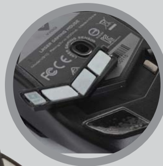
底部有几块磁铁配重，玩家们可以根据自己的手感自行微调鼠标重量。
