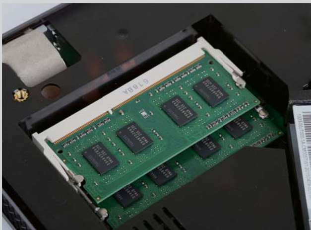
>> 内置的两根2GB DDR3L-1600内存, 组成双通道, 共4GB容量。
