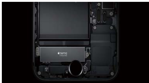
>> 全新的 Home 键和 TapticEngine 震动引擎协同工作,Home 键不再能够按压,而是通过振动引擎提供触感反馈。
