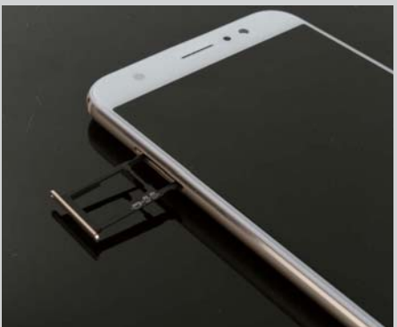
>> 360 N4S也为单卡槽双卡位设计，卡槽设计为SIM卡+TF卡拓展设计。
