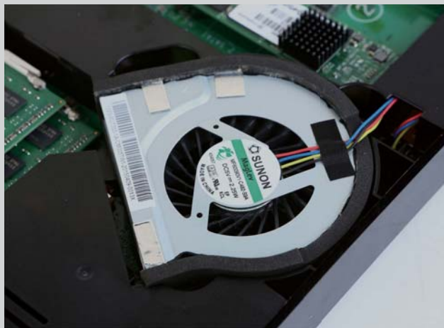
>> 主动式散热风扇保证了处理器及内部拥有更好的散热环境
