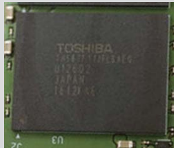
浦科特M8Pe和东芝饥饿鲨RD400均使用东芝原厂同一型号15nm Toggle V-NAND MLC闪存
