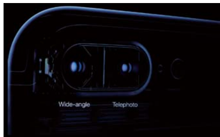
>> iPhone 7 Plus 采用了短焦 + 长焦镜头的组合方式,它可以实现 2 倍光学变焦、10 倍数码变焦。
