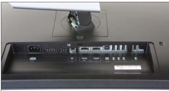
■ 戴尔UP2715K接口部分,需用两根DP同时接驳才能实现5K。
