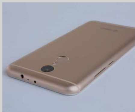
>> 360N4S机身顶部是3.5mm耳机孔、降噪Mic和红外接口
