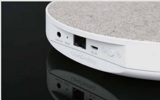
>> LavaDesktop的背面有四个插口和一个按钮，从左到右依次是3.5mm音频接口、RESET孔、RJ-45接口、电源接口、蓝牙切换按钮。
