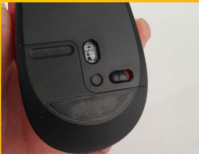
■ 打开M336底部的开关,长按蓝牙适配按键,直到顶盖上的指示灯闪烁,进入待配对状态。
