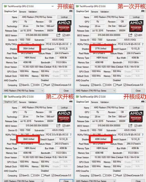
■ “2good4you”秀出的开核前后GPU-Z规格截图, 可以看到流处理单元和纹理单元数量的增加。
