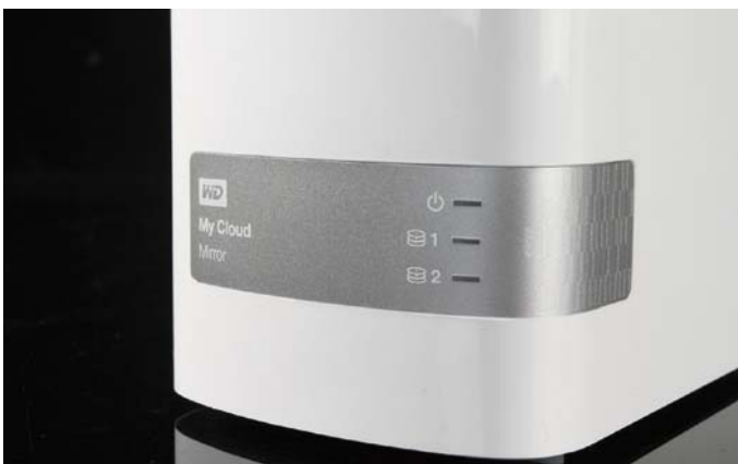
■ 三个蓝色的LED灯，一个代表电源，另两个则代表硬盘状态，在蓝色长亮时表明工作正常。
