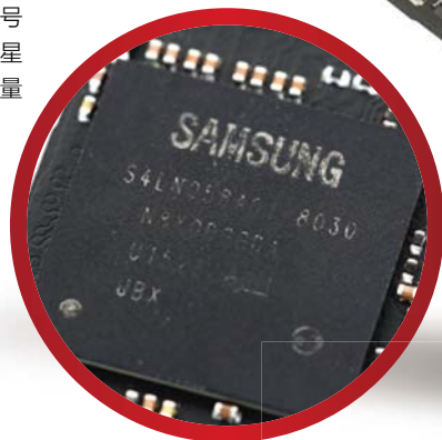
■ 主控为三星UBx（编号S4LN058A01），支持PCI-E 3.0 x4模式、NVMe 1.1标准及部分企业级特性，目前并没有太多这颗控制器的信息。
