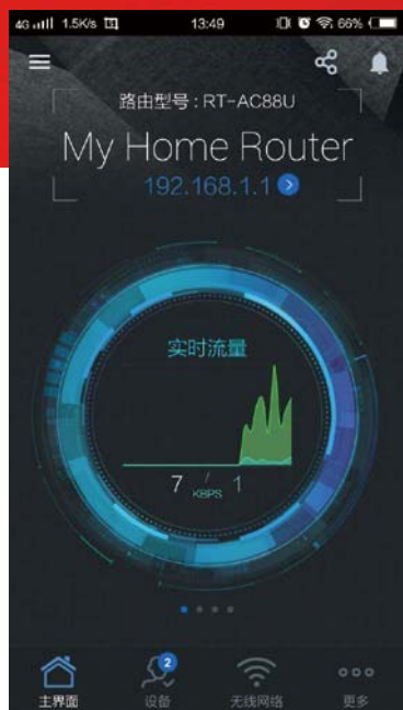
■ 主界面上可以看到路由器的基本信息，如实时流量、接入客户端数、CPU占用等。
