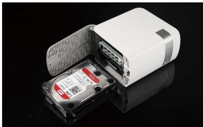
■ 顶盖有一个开关轻触可以打开，可以看到里面的两块WD 3TB红盘，取下中间的螺丝即可将硬盘取出。
