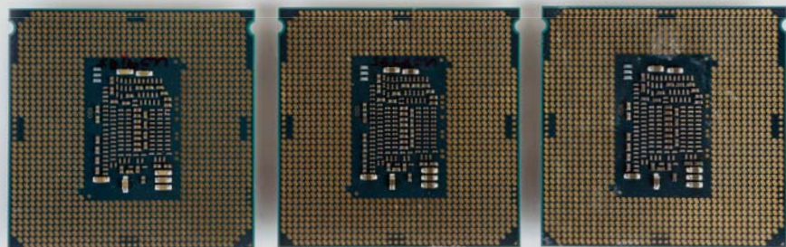
■ 同样在处理器背面,三款处理器的电容数量、排列方式也完全相同。
