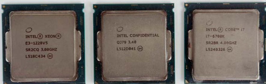
■ 参与测试的至强E3-1230 v5(中)处理器为工程版产品,至强E3-1220 v5(左)则为市售版产品,可以看到除了型号标识外,它们与Core i7 6700K处理器(右)在正面没有任何区别。
