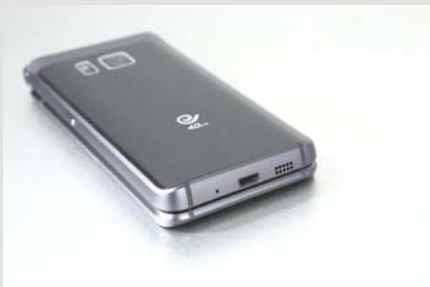
>>> 玻璃后盖下内置了无线充电线圈,无线充电器需另行购买。有线充电则加入了急速快充功能,实测半小时可充电43%。
