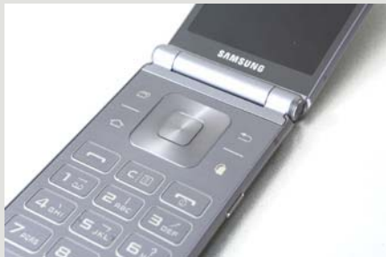
>>> 键盘功能区拥有四向方向键和HOME键、多任务管理按键、返回键、SIM卡切换按键。四向按键操作起来比触控繁琐一些,小编更多时候是一手持机、一手触控。
