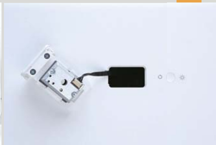
>> 1代的感应器部分，可以抠开面板直接取出。
