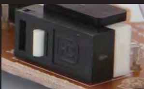
■ 左右按键采用的仍是赛睿自家的定制橙点微动，3000万次点击寿命。中键则使用了TTC的硬红点，侧键应该是IC的软白点。
