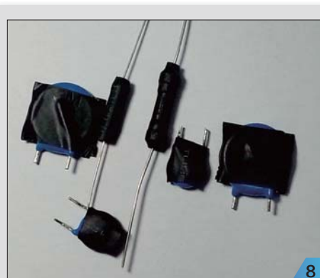
■ 包裹处理之后的元器件。注意,为了方便后文中演示防雷器效果,笔者没有给GDT装套管,实际操作时不能落下。
