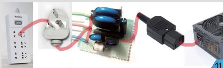
■ 封装、连接示意图,有条件的玩家最好用RTV胶或者热熔胶将防雷器主体灌封。
