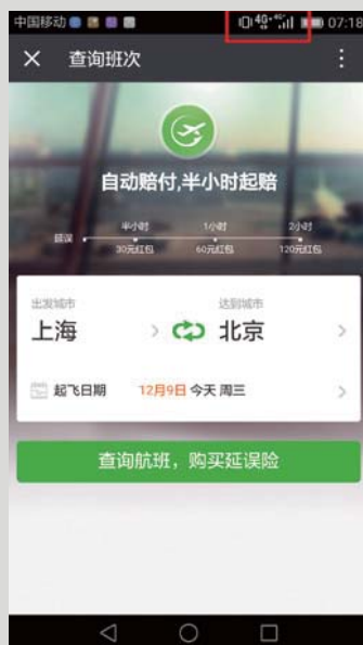
>> 华为Mate 8最高支持Cat.6网络，在基站支持的情况下可以使用4G+。
