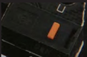
■ 左右按键采用的仍是赛睿自家的定制橙点微动，3000万次点击寿命。中键则使用了TTC的硬红点，侧键应该是IC的软白点。
