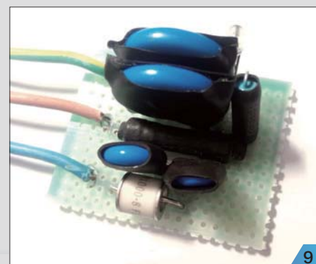
■ 包裹处理之后的元器件。注意,为了方便后文中演示防雷器效果,笔者没有给GDT装套管,实际操作时不能落下。
