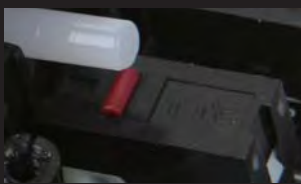
■ 左右按键采用的仍是赛睿自家的定制橙点微动，3000万次点击寿命。中键则使用了TTC的硬红点，侧键应该是IC的软白点。
