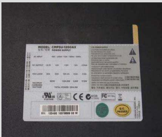
■ 一个合格的电源名牌应包含额定功率、12V负载比例、5Vsb限流、认证标识等关键项目，一个优质电源的名牌信息应是详尽的。
