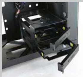
>> 硬盘架的位置相当灵活，你能在多个角度任意放置，方便用户DIY水冷系统时更好地走管、布局。
