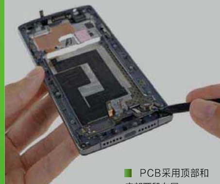
■ 中框上的大面积石墨散热层
