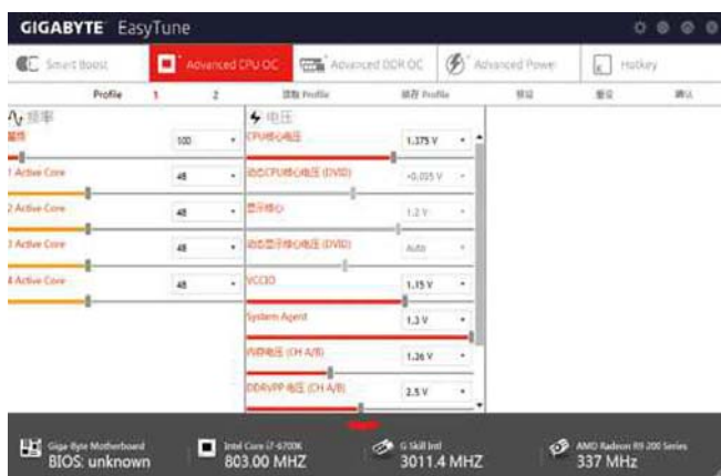
■ Advanced CPU OC超频功能具备非常丰富的超频选项，已可完全满足风冷超频的需要。
