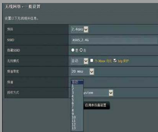
在路由器固件中,选择使用率最少的频道就能明显降低干扰提高速度。
