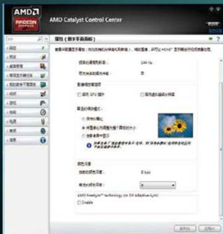
■ 在驱动控制面板中需要开启FreeSync后，才能完全启用FreeSync功能。
