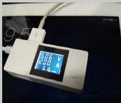
>> 对于平板来说，这款USB充电器能够提供5V/2A的电流，保证了充电速度。
