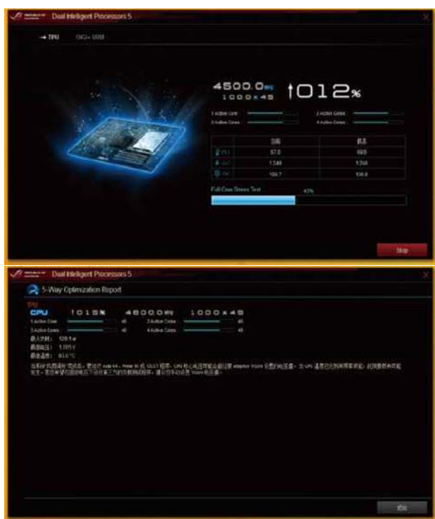
■ 启用五重优化自动超频时，每提升x1倍频主板即会对处理器进行压力性测试，并会在达到目标超频频率后，调整主板供电相数，这样的超频调节能力可以说已经比普通用户专业。
