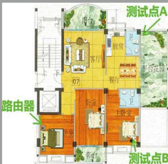
第一部分测试(测试1、测试2)环境示意,我们分别测试了该环境最容易丢失信号的A、B点无线信号的覆盖变化。
