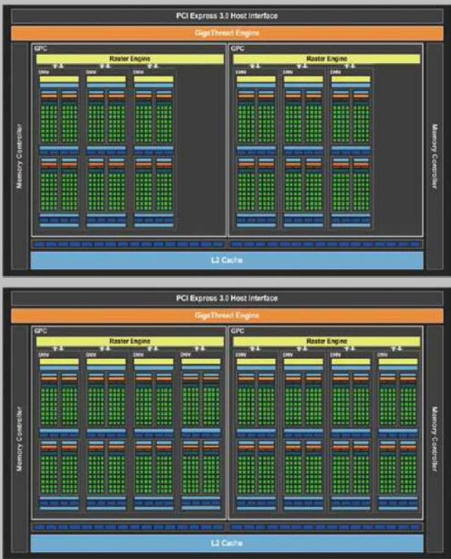
■ GTX 950使用的GM206-250核心架构示意(上),可以看出它和GM206-300核心架构(下)的结构基本一致,只是每个GPC模块中减少了一组SMM单元。
