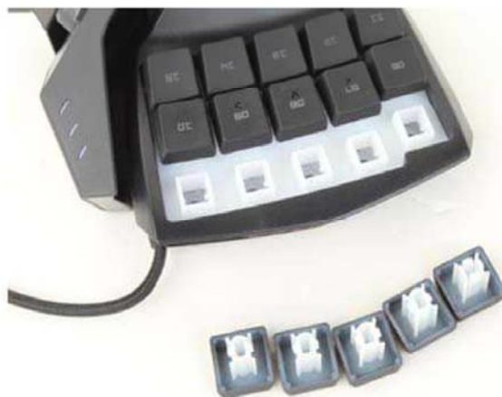
■ 塔洛斯魔蝎幻彩版使用的不是机械轴，而是火山口的薄膜按键。通过拔出的键帽，我们可以看到，塔洛斯魔蝎幻彩版的键程是比较长的。
