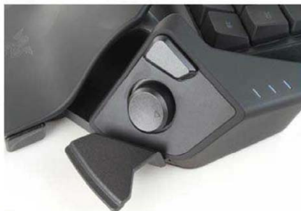
■ 侧面是一个四维的游戏摇杆以及两个按键，大的一个按键预设的是“空格”键。
