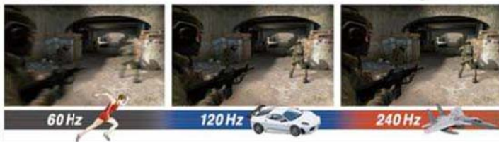
■ 144Hz刷新率只是大部分游戏显示器的一个高度，个别游戏显示器已经高达240Hz了，更高的刷新率在画面过渡时更为平滑。
