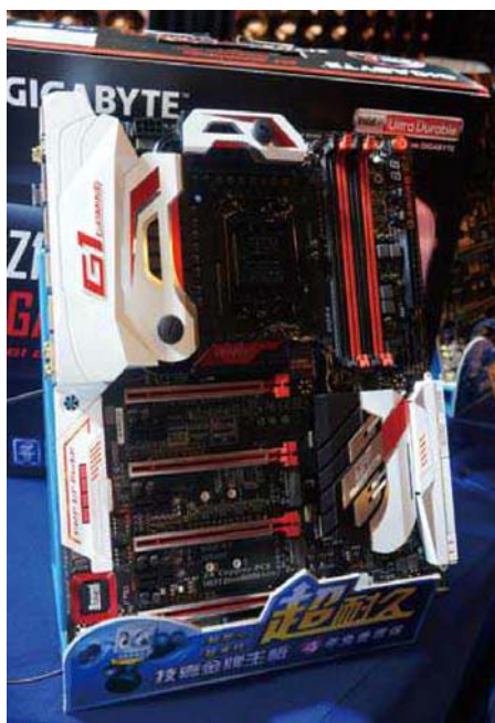
■ 图为技嘉Z170游戏主板中的旗舰级产品：GA-Z170X-Gaming G1，它采用水冷头、散热片一体化设计，并配备标准水冷接口(G1/4)，可以让玩家方便地为主板搭建水冷系统。同时它还支持组建四路显卡互联技术，而创新ZxRi 120dB+音效与杀手专业游戏网卡X3则能在音频与网络上为玩家提供更好的体验。
