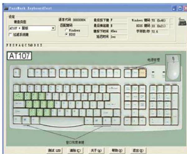
■ 按键冲突测试示意图(预设的按键就是Tab键到R、Caps到F以及Shift到V)
