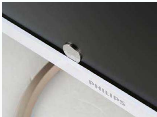
■ 显示底部边框与屏幕间的缝隙较大，不仅影响整体美观，还容易进入灰尘。
