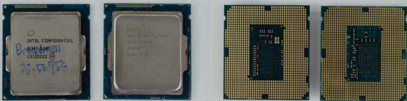
■ 工程版Core i5 5675C处理器(左)对比Core i5 4460处理器，从以上对比不难发现，虽然它们在正面上非常相似，但在处理器背面，Broadwell台式机处理器的电容少了很多，表明新工艺的采用降低了处理器的供电需求。
