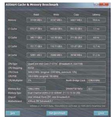
通过AIDA64测试可以看到, Broadwell处理器内置的eDRAM读取带宽即测试中的L4 CACHE远高于双通道DDR3 2133内存, 在访问延迟上也更低, 是其性能增长的关键因素。
