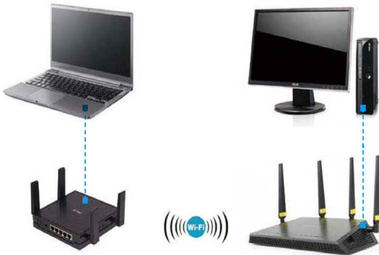
■ 测试平台连接示意，R7500和平台1通过千兆有线连接，平台2笔记本和EA-AC87通过千兆有线连接，接收来自R7500的无线信号。
