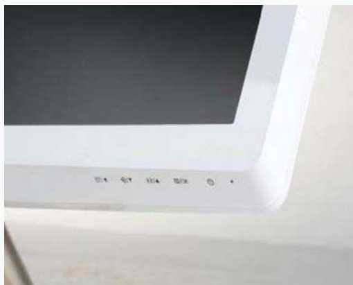
■ 设计在显示器下边框底部OSD触控式按键使用特别不方便
