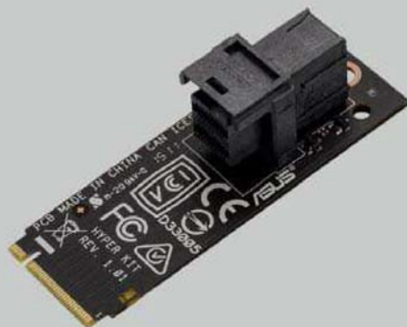
■ Hyper Kit转接器可将M.2转换为U.2接口,并且不会损失性能。
