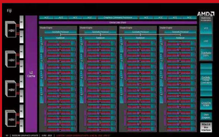
■ Fiji核心架构示意图(左),除了显存控制器模块的明显变化,它相比之前的Hawaii XT(右)主要就是暴增了流处理器单元,注意看右侧的功能模块区和顶部的ACE等单元,两者几乎完全一样。
