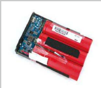
>> 华硕ZenPower采用的是MPS的二合一主控——MP2636，并采用了三节三洋18650电芯，单节电芯容量为3350mAh。
