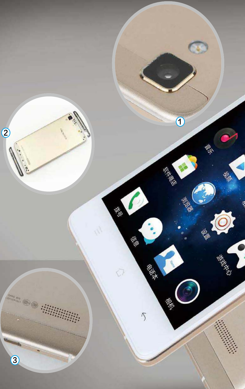
图1:OPPO R7的主摄像头边缘略微突出, 不过已经可以接受了; 毕竟对于一款机身厚度仅为6.3mm的超薄手机来说, 不是火山口摄像头就很不错了。 图2:在机身背部的两端, 可以看到两个长条形的区域, 质感和机身背部的铝镁合金有一定差异。这里其实就是两个塑料封条, 下面隐藏着固定机身的螺丝。 图3:扬声器被设计在了机身背部, 一般来说这种设计容易造成手机平放桌面时音孔被遮挡, 不过OPPO R7倒没这种问题, 因为它背后设计有凸点支撑。 图4:OPPO R5曾经因为机身过薄而不得不使用USB转音频的方式, 而OPPO R7上的耳机插孔则重新回归传统, 3.5mm的耳机插孔显然更方便一些。 图5:OPPO R7采用纵排的双卡单卡槽设计, 可以支持micro SIM卡和nano SIM卡。其中nano SIM卡位采用与或卡槽设计, 可用于最大128GB TF卡存储扩展。 图6:只有真正使用过, 才能明白快速充电技术的价值。可以说, VOOC闪充功能就等于为OPPO R7这样的超薄手机提供了第二块备用电池。
