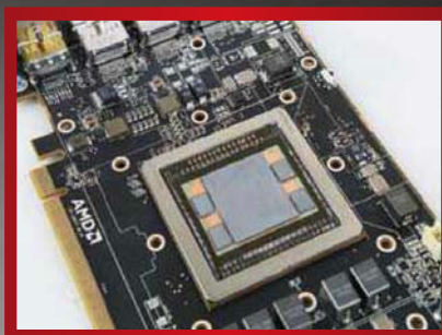
■ Fiji核心Die，注意看GPU周围四个较小的Die，那就是HBM显存，看到明显泛黄的部分了吗？那就是裸露出来的中介层。
