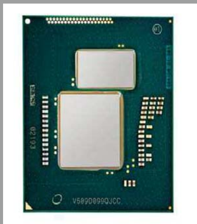
■ Broadwell-H的封装图，和之后的Broadwell-DT在架构和排布上完全相同。上部是128MB eDRAM，下方则是处理器核心本体。
