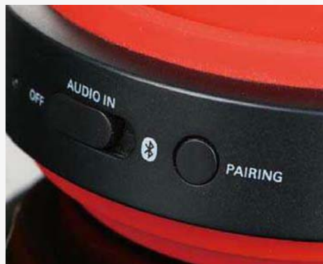
三段式的开关设计，可以在关机、Audio In以及蓝牙这三种状态间切换，旁白有指示灯，圆形的按键蓝牙配对键，起到中断蓝牙连接和进入蓝牙配对模式的作用。
