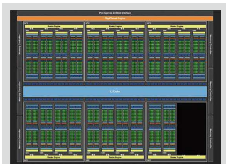
■ GM200-310(GTX 980Ti)核心架构跟GM200-400(GTX TITAN X)一致，SMM结构完全一样，GPC也都是6个，只是GTX 980Ti其中的一个GPC只有2个SMM单元，因此少了256个CUDA单元。
