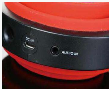
相比常见AUX In接口和Micro USB充电接口，它们旁边的这个圆形小孔可能会让人更好奇，考虑到它可以“变形”的特点，这其实是一个气孔。
