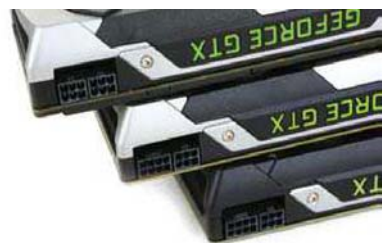
■ GTX 980、GTX 980Ti、GTX TITAN X(从上往下)外接供电对比,GTX 980Ti和GTX TITAN X一样是8Pin+6Pin配置,供电需求明显比GTX 980的双6Pin更高。
