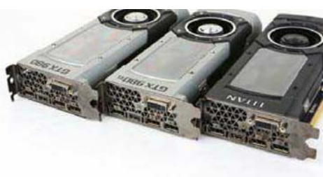
■ GTX 980、GTX 980Ti、GTX TITAN X接口对比,清一色地采用了DP×3+HDMI+DVI的配置。
