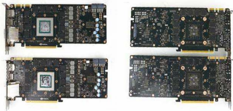
■ 公版的GTX 980Ti PCB布局(下)上则和GTX TITAN X(上)几乎完全一致, 唯一的区别是背面少了12颗显存颗粒。
