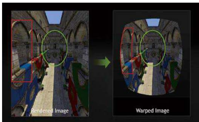
■ 传统方式渲染画面(左)和多重分辨率着色渲染画面对比，传统方式渲染了太多不会显示的图像边缘，导致了性能浪费、帧率更低。
