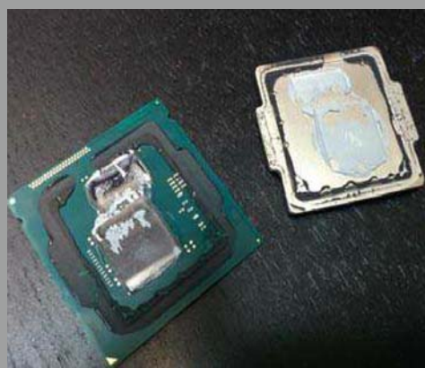
■ 被超频发烧友开盖的Core i7 5775C，可见其结构与Broadwell-H完全相同——由一块小型芯片即128MB eDRAM与处理器核心芯片组成，同时仍使用普通硅脂导热，据悉其超频能力表现很一般，要稳定在4.4GHz下，需要1.4V的电压。
