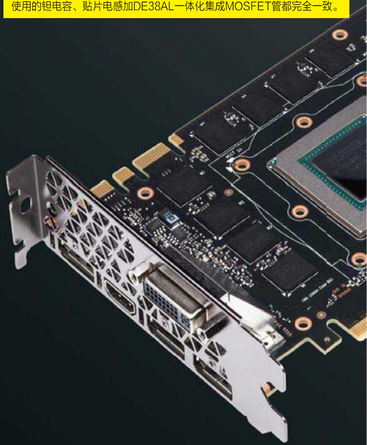
公版GTX 980Ti(左)跟GTX TITAN X一样使用了6+2相数字供电设计,连使用的钽电容、贴片电感加DE38AL一体化集成MOSFET管都完全一致。
