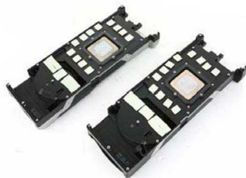
■ 公版GTX 980Ti(左)的散热鳍片与GPU的接触面也采用了均热板设计, 和GTX TITAN X如出一辙。
