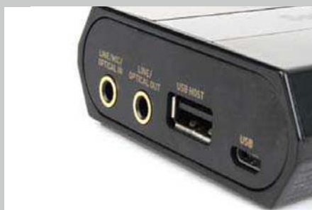
>> E5的主要接口集中在背部，包括USB HOST、Micro USB以及3.5mm的输入、输出接口。
