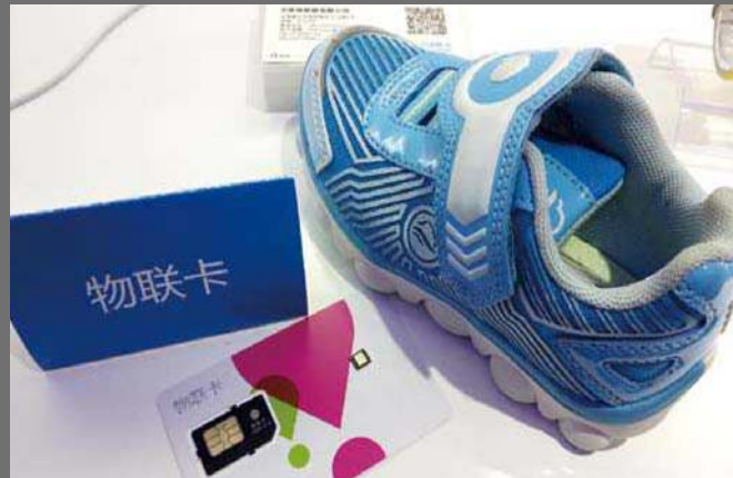
>> 在中国移动的展台,我们看到了基于物联网的运动鞋,它的特点是可以直接通过 SIM 卡连接移动网络进行即时定位。
