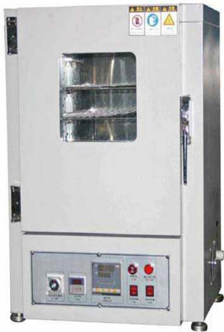
>> 测试电池热冲击性能的高温试验箱
