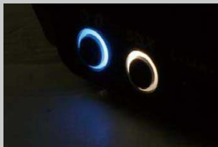
>> 通过有线连接方式时电源开关和SBX按键的灯光都是白色的，当移动设备通过手机与E5连接时，电源开关的灯光会变成蓝色。
