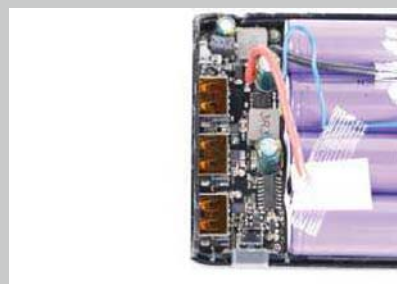
>> 可以看到Anker 25600mAh在PCB端的用料相当豪华
