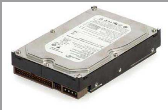
■ 硬盘之前使用的也是并行传输的IDE接口（图为典型的IDE硬盘），后来全部转为目前的串行SATA接口。相比之下，采用芯片内连线的eMMC在很大程度上延缓了并行架构的寿命。
