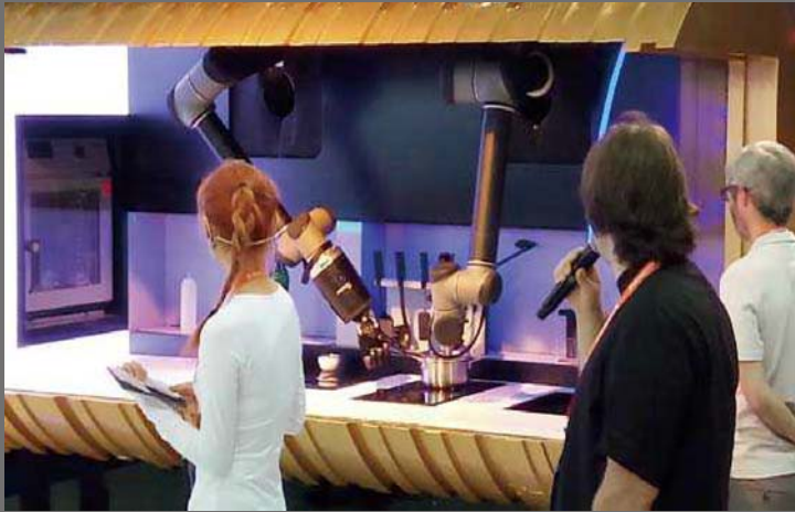
>> 说到智能家居, Moley Robotics 展台的智能厨房机器人应该是关注度最高的。源自工业制造领域的机械臂被引入了厨房, 可以复制厨师的全部操作。
