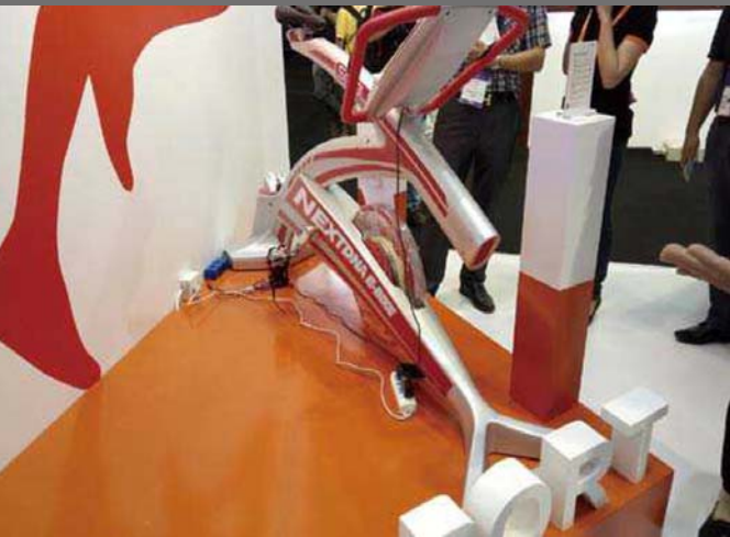
>> 声物科技展示了一款健身车, 它可实现动能转化为电能并直接供电和存储, 同时还在车前部加入了投影功能。
