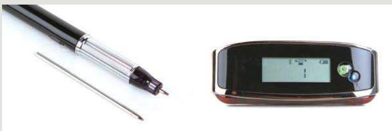
>> 海尔IP21数码笔采用和普通签字笔类似的圆珠笔芯来实现纸质书写,用完后可自行更换。
