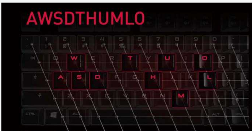
■ 在RK技术支持下，每个按键都是一个独立的确认节点，不存在扫描确认时间差，因此能做到真正的全键位无冲。
