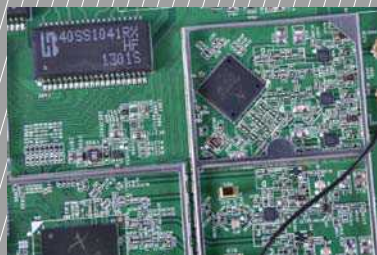
■ 网件R4300采用了AR9344+AR9580的双芯片方案。主控AR9344中集成了802.11n 300Mbps无线芯片，但仅支持2.4GHz频段，所以又添加了Atheros AR9580，提供3×3MIMO 450Mbps的5GHz 802.11n接入能力。
