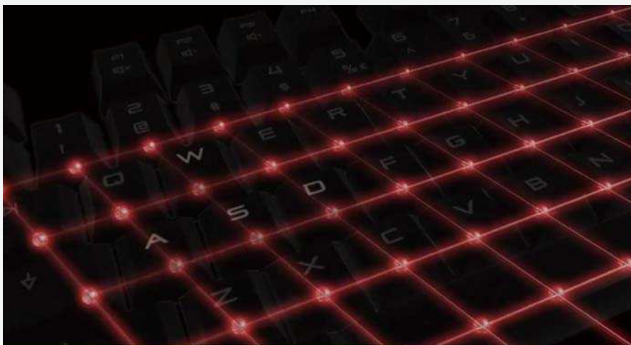
■ 在RK技术的支持下，控制器不再以固定频率进行横、竖信号的扫描，而是将每一个按键都作为了一个独立的触发点，并直接和控制器链接。
