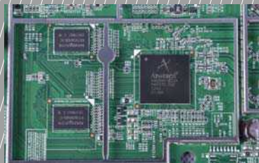
■ 网件R4300的主控也来自Atheros，型号为AR9344。相比AR9130它的最大优势是主频提高到550MHz，且搭配DDR2内存。R4300就搭载了两颗来自南亚的DDR2内存，总计128MB。
