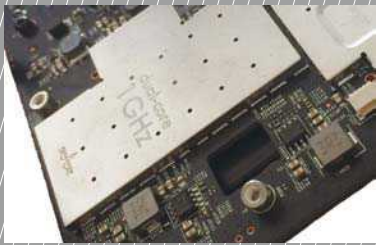
■ 小米路由器的内存高达256MB，但闪存只有16MB，不开放刷写第三方固件。
