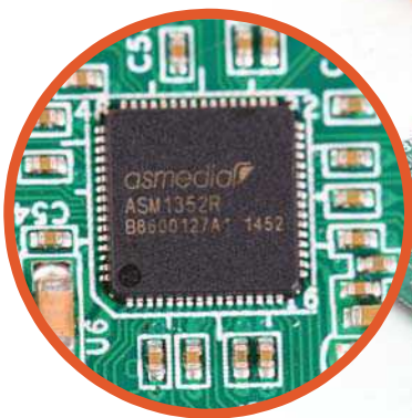
■ 测试基板上具备RAID功能与SATA TO USB 3.1桥接能力的祥硕ASM1352R芯片
