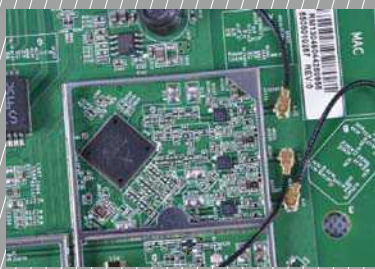
■ 网件R4300搭配了内置5天线，5GHz频段为3根，2.4GHz频段为2根，放大电路比较完善。
