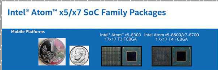
■ Atom x5-8300处理器和Atom x7-8700处理器对比一元人民币以及10美分,可见其小巧玲珑。
