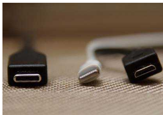
■ USB 3.1 Type-C接口(左)与雷电(中)、Micro USB接口(右)对比, 更大、更厚实。
