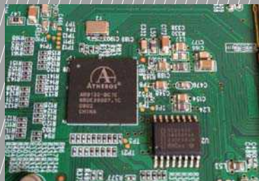
■ TP-Link WR841N的主控是来自Atheros的AR9130-BC1E，主频400MHz，与之搭配的内存是海力士HY5DU561622FTP-532MB DDR。
