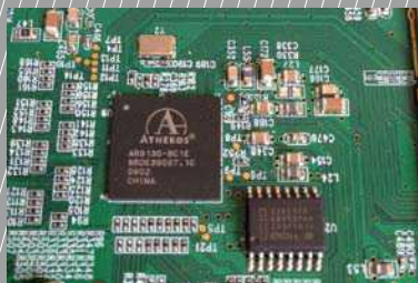
■ TP-Link WR841N的无线芯片被整合在主控当中，AR9130既是主控，又是无线网络控制芯片。提供300Mbps的802.11n无线网络，仅支持2.4GHz频段。
