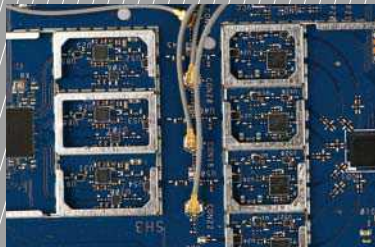
■ 华硕RT-AC87U使用了外置4根，等效7天线设计，其中3根2.4GHz和5GHz频段复用，1根5GHz独享。相对应的7路信号放大电路皆采用独立设计，电路不仅完善，元件规格也非常出色。
