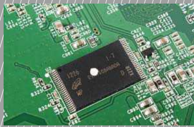
■ 网件R4300使用了镁光的Micron29F1G08ABADA FLASH颗粒作为系统的存储器，容量为128MB，具备了刷写三方固件的基础。
