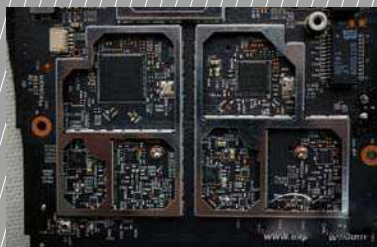
■ 小米路由器使用了内置4天线方案，2.4GHz和5GHz频段各分2根，都采用了干扰最小的独立电路设计。
