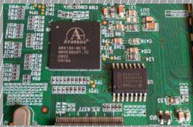
■ TP-Link WR841N的闪存规格太低，容量仅16MB，没法再改造固件。
