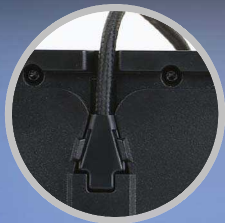
非常紧凑扎实的编织线材，接口部分应该是镀金设计。看到USB连接线，你或许会下意识地认为它跟MX Board 3.0采用的是可分离时线缆，其实真不是！它只是为了拆解方便而设计的一个卡扣式结构。
