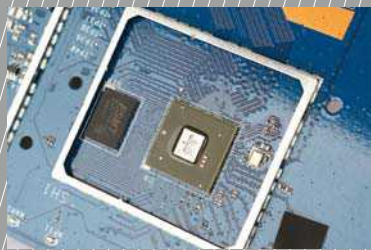
■ 华硕RT-AC87U也搭载了博通BCM4709主控，双核心1GHz设计，并搭配ESMT的256M DDR3内存(M15F2G16128A)。
