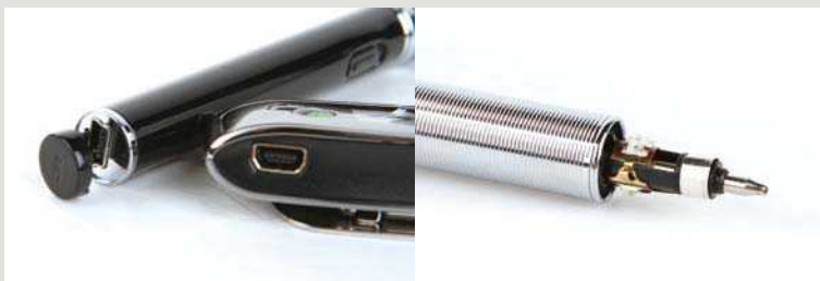
>> 在笔的末端以及接收器的背后设计有miniUSB接口,用于充电和数据传输。
