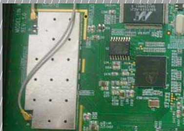
■ TP-Link WR841N使用的是2根天线，简单、成熟。
