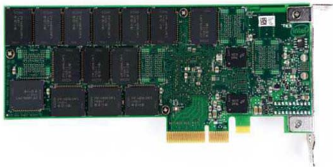
■ 正反两面配备总共32颗英特尔20nm闪存，5颗总容量1.25GB的美光DDR3 1600内存颗粒作缓存。
