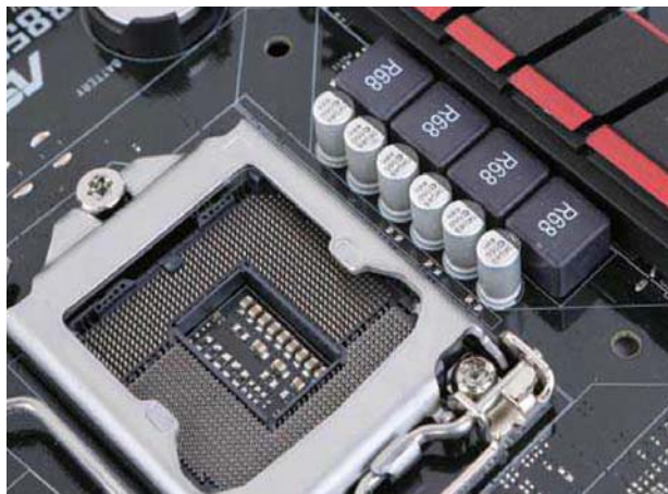
■ 在供电电路方面，丰富的定制选项，全面平衡每相电路的电力负载；全数字化动态调整，能显著提升在低温时的超频稳定性。
