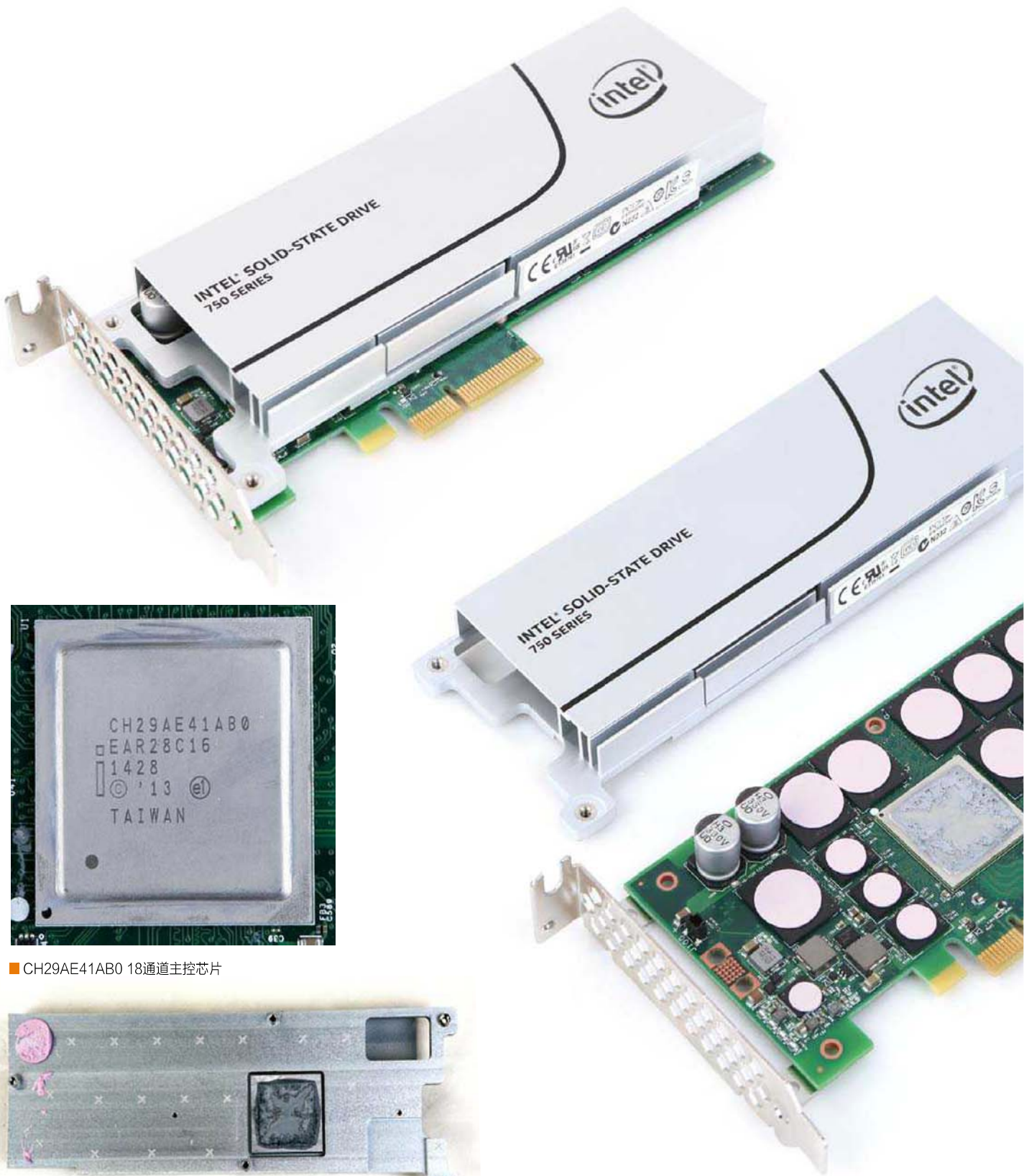
■ 固态硬盘正面覆盖有大型铝制散热片
