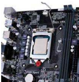
■ 可以看到，借助防盗螺丝设计，即便CPU压杆已经松开，小偷也无法取下处理器。
