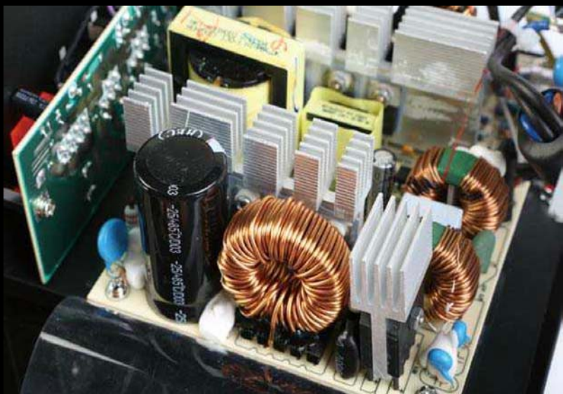
■ 厚实的高品质PFC电感，配合上双MOS整流桥堆，让MVP 600具备了90~264V的宽域网接入能力，能保障业主的机器在全国任意区域的电网中正常工作。
