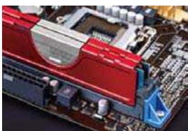
■ 华硕网吧主板上的锁扣可将内存两端的卡子锁死，如不去掉锁扣，小偷就无法取下内存。
