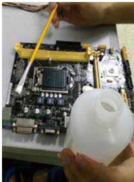
■ 采用镀膜技术的主板可有效降低故障率，具备防潮、防尘、无毒、无味的特点。
