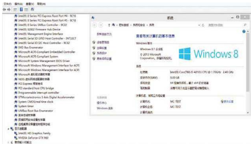
■ 在连接了安装就绪的显卡扩展坞后，可以在系统中发现Alienware 13的显卡配置变成了GTX 960。
