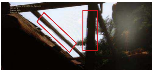
■ 在刷新率高于帧率下，可以看到未开启FreeSync时，场景开始时出现的房子旁边的木架有严重的撕裂现象。
