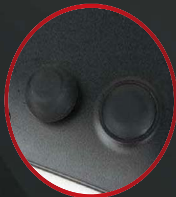
在键盘的背面上 部，赛睿为APEX M800设计了一高一 矮的两个可替换式橡 胶脚垫。玩家可以根 据自己的需求自由设 定键盘的倾斜角度， 以便适应自己的使用 习惯。
