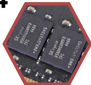
① 配备SK海力士DDR4 2133颗粒,其标准CL工作 时序为CL15与CL16。
