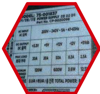
② 电源上的铭牌表明VS650 +12V输出功率可达到600W
