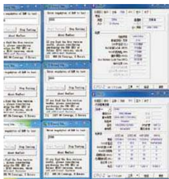
① 在DDR4 3000下,该产品无错通过了时间长达12小时,覆盖率达到900%以上的MemTEST内存稳定性测试。
