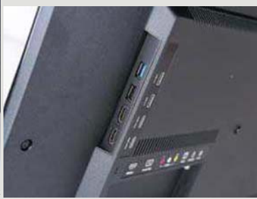
>> 机身侧面安排了两个HDMI接口和两个USB接口，USB 2.0和USB 3.0各一个。这两类接口是大多数消费者在智能电视机上最常用的，设计在侧面方便插拔，细节考虑周到。
