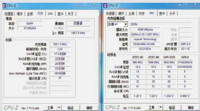
■ 如只是追求频率超频,其四根内存最高可同时提升到DDR4 3300。
