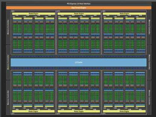
■ GTX TITAN X架构示意，GPC模块和显存控制器模块数量都从GM204的4个增加到6个。每个GPC模块下辖的SMM计算集群数依旧是4个，和GM204、GM206一致。
