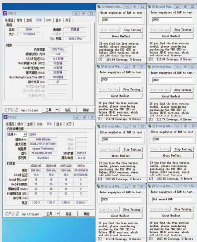
■ 在将电压提升到1.38V后,内存可以无错通过MemTest 200%覆盖率测试。
