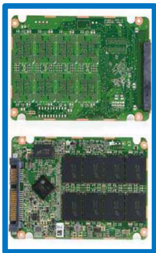
① 英睿达BX100 500GB固态硬盘由8颗64GB 16nm美光MLC闪存，一颗512MB缓存，以及一颗慧荣SM2246EN主控组成。
