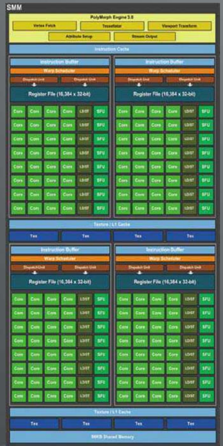
■ GTX TITAN X底层SMM单元，结构和布局基本跟GM204(GTX 980)、GM206(GTX 960)的SMM模块完全一致。
