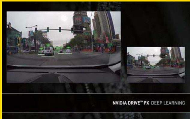
■ Driver PX系统可以自动识别道路信息，实现自动停车、自动驾驶等。
