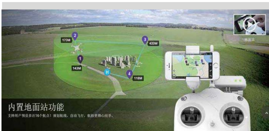
>>目前的消费级无人机一般使用夹子使得遥控器和手机“合体”,手机充当显示设备。
