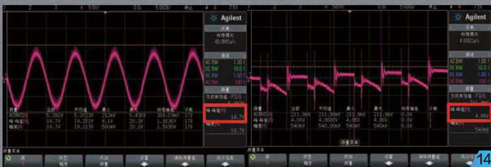
■ 加上薄膜电容后, 母线上的高频纹波表现, 相比原厂峰峰值明显降低, 优化效果开始显现。(原厂纹波表现峰峰值36.8V、>5.11V, 幅度分别为18.1V、580mV)
