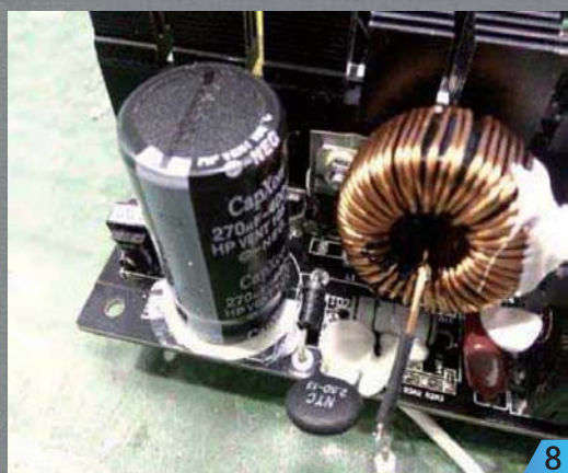
■ GP600G的母电容预留空间其实相当大,可见设计之初有考虑过较大冗余,跟最后的量产有所不同。
