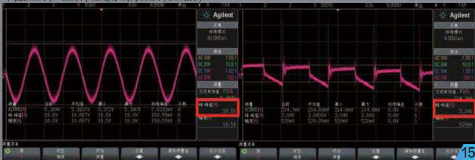
■ 添加薄膜电容跨接PFC二极管与母电容后, 电源纹波表现的峰峰值得到进一步优化。
