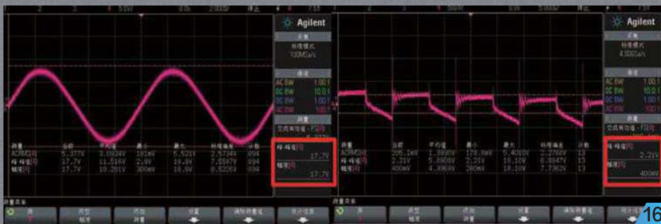
■ 添加薄膜电容跨接PFC二极管阴极与MOS管后, 电源纹波表现不仅是峰峰值得到优化, 幅度也开始缩小。
