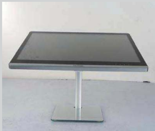
① 显示器能支持接近180°平躺的仰角调节
