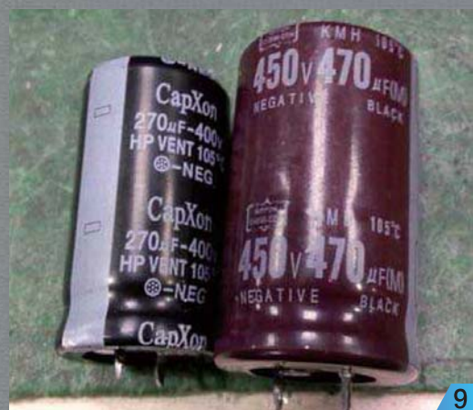
■ 量产GP600G使用的电容(左)与 \Phi 30 \times 45 电容体积对比。
