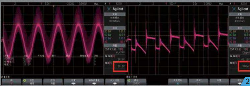
■ GP600G原配母电容下的纹波表现, 左图为工频纹波, 右图为高频纹波(下同)。
