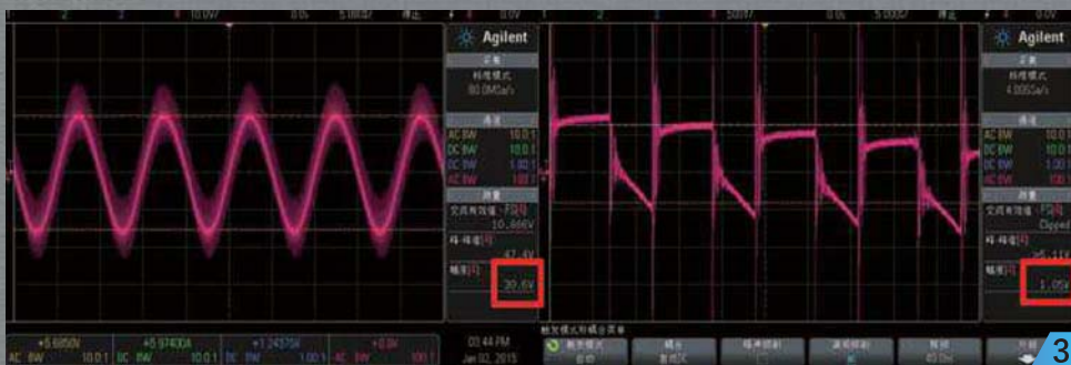
■ 将GP600G母电容削减到180 \mu F后的纹波表现, 可以看到对比原厂状态表现大幅下降, 波动幅度甚至成倍劣化。(注意对比红框内数据)
