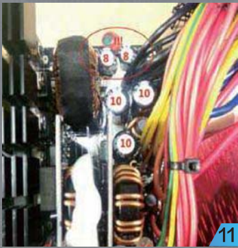
■ GP600G的输出端电容(数字表示电容直径,单位:毫米)。圈出的两个电容就是“很难通孔”的典型,它们是-12V路径上的,并不十分重要,改也影响不大。
