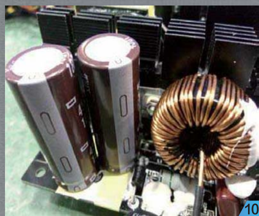
■ 本次母电容改造最终选用了两枚 180\mu\text{F}/450\text{V} KXG电容并联的方案。
