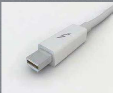
■ 苹果的雷电接口其实是一种复合型的Mini DisplayPort接口
