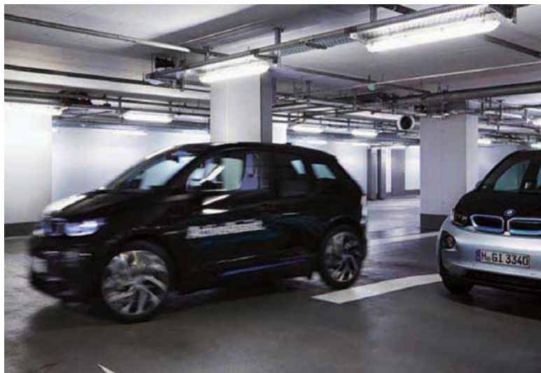
>> 宝马 i3 上的这套泊车系统能够从车辆进入车库开始直到在车位上停稳，实现全程无人操控。
