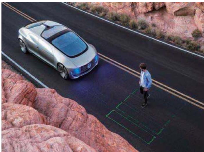
>> F 015 Luxury in Motion 可以利用激光投射技术为行人投射出一条临时的人行横道
