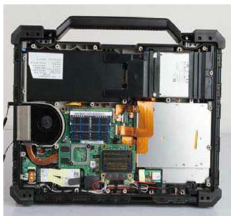
■ 机身底盖虽然采用众多螺丝固定,闭合紧闭,但没有隐藏卡扣,将所有螺丝拧下后即可打开。由于外壳坚固,因此机身内部没有采用防滚架设计。机身内部空间宽裕,便于散热。值得提出的是,为了起到三防效果,内部散热风扇采用了隔离设计,因此用户不用担心液体、沙尘等异物会从此处进入机器内部。
