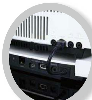
■ 妙韵音乐系统和底座通过BoseLink接口连接。前者的接口能实现常用的有线输入，而底座的接口则更加丰富。
