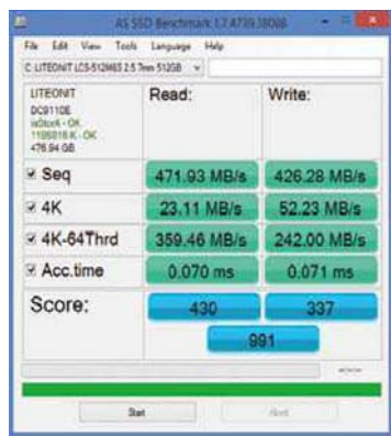
■ 戴尔Latitude 14 Rugged Extreme配备了一块建兴512GB SSD(支持热插拔),通过AS SSD测试,其随机读写速度均达到400MB/s以上,综合得分991,表现出色。
