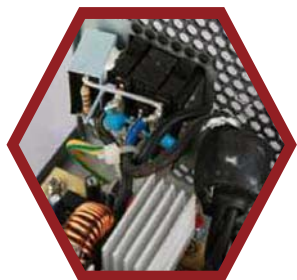
① 完善的一、二级EM 滤波电路和输入端电路设计。
