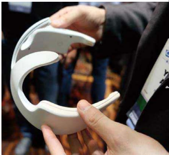
>> MyBrain Melomind 智能耳机有四根突出的电焊条,每根电焊条上都带有电极。这些电极可以像标准的脑电波图(EEG)一样测量用户的脑电波,并把大脑运动的数据传送到匹配的 App 中。
