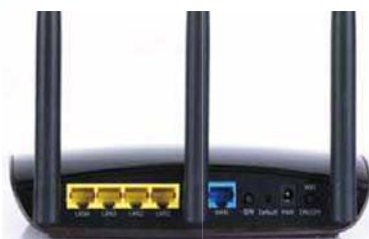
① 磊科AC1无线路由器背面除了常规的LAN口和WAN口外，还设计有无线信号按钮、RESET按钮和Wi-Fi开关按钮。
