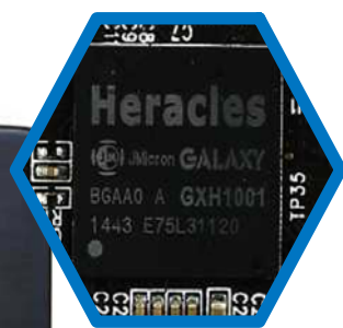
① 由影驰与JMicron智微科技联合研发的“Heracles”海格力斯主控芯片，打上了JMicron智微科技与影驰的标识。
