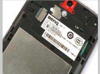
>> F5的背壳可拆卸，但电池不可更换，主要是MicroSD卡扩展槽和SIM卡槽在里面。
