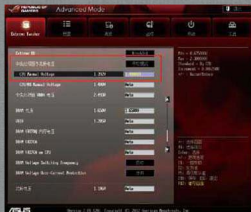
■ 要想将FX 8300频率提升在4.5~4.6GHz下,需设置1.4V左右的CPU核心电压。
