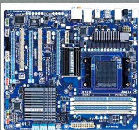
■ 采用多相供电设计的AMD 900系列主板是FX 8300处理器超频的首选。
