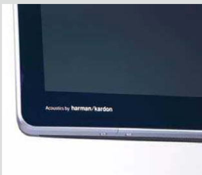
■ 由于加入了3H硬化涂层防眩光玻璃，所以面板看上去更加一体化。
