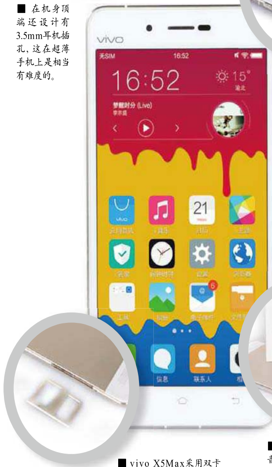
■ vivo X5Max采用双卡双待,属于全网通机型,其中的与或卡托允许在Nano SIM卡或TF卡之间互换。
