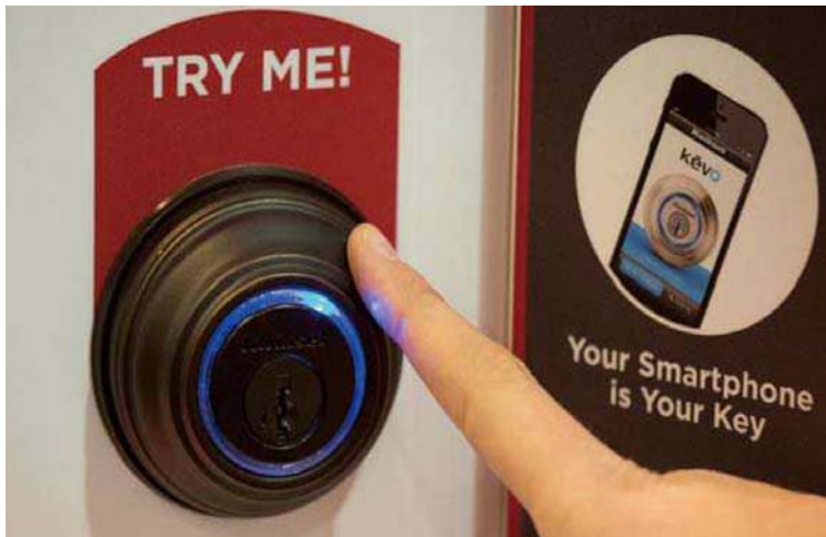
>> Unikey 无线电子锁通过蓝牙与智能手机匹配，核实身份后用户只需用手指触碰门锁便可打开或关闭大门。
