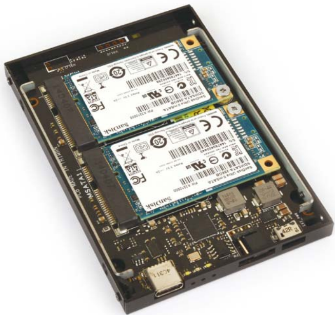
高性能USB 3.1存储设备的内部结构,通过在内部组建mSATA RAID 0磁盘阵列,从而获得超强的性能。
