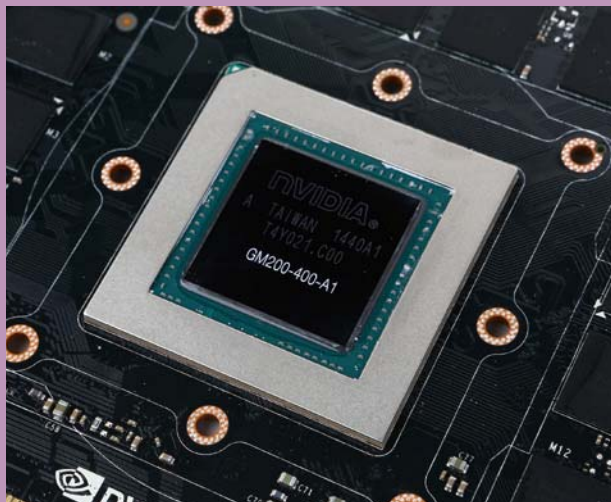
GM200核心和上代GK110核心使用同样28nm工艺制造，却在性能几乎翻倍的同时，还能保持功耗不提升，甚至反而比GK110低。让不少玩家都觉得“老黄”掌握了黑科技。
