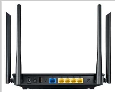
>> 端口配置一览,网络部分的端口属标准配置,USB 2.0接口扩展了路由器的功能。
