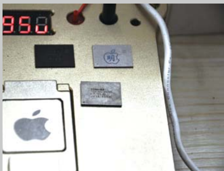
■ 这是即将进行升级替换的存储颗粒。大或不大，当然不是看体积，就是这么一颗存储芯片，容量有大有小，我们就是要把升级手机主板上原来的16GB存储芯片取下，然后换上写好序号信息的128GB存储芯片就OK。
