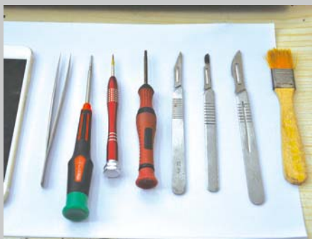
■ 向大家展示一下即将用到的部份拆机工具，螺丝刀就有三种。“手术刀”也有三种，由左向右为11号、15号、23号手术刀，感觉是不是像医院的外科医生？
