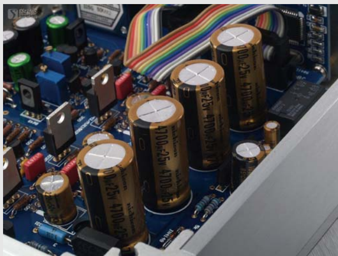
■ 滤波电容决定电源的稳定性
