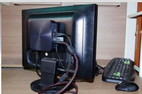
■ 通过VESA MOUNT将UN62挂在显示器背后, 安装上所有线缆和附件之后, 可以看到相比传统PC, 不论是占用的空间还是线材的复杂度, 都要简单很多。
