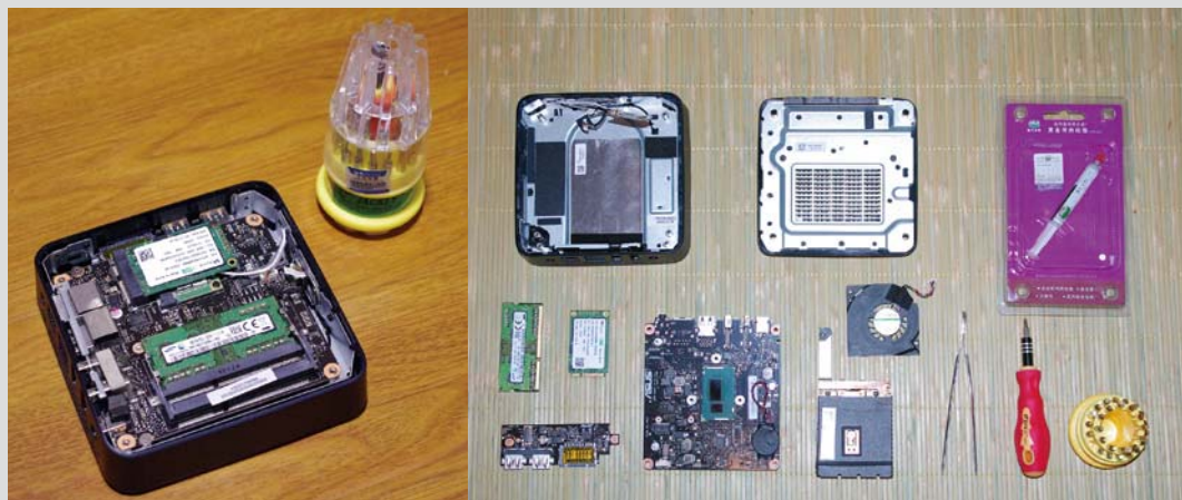
内部的设计还是十分规整的，主板采用了黑色的PCB，I/O接口处的金属织物是用来防静电的，做得非常到位。
