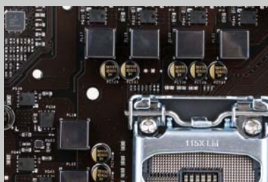
>> 主板采用做工较好的7相处理器供电系统
