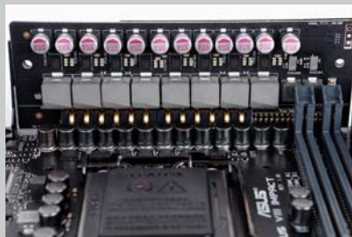
>> 由IR3553 MOSFET、10K黑金固态电容、粉末化合金电感组成的IMPACT POWER III供电系统。
