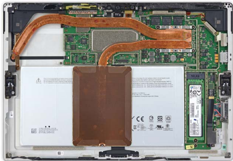
■ 打开后盖的Surface Pro 4，请注意左上角的热管位置属于空置状态，没有任何设备。
