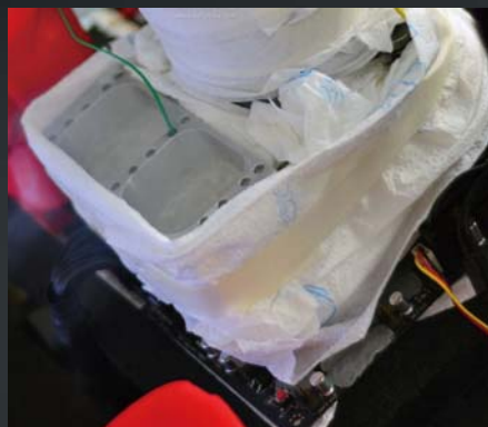
在当时为了实现内存3600MHz这一频率，超频玩家为内存与CPU同时使用了液氮这样的极限散热手段。
