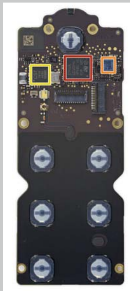
■ 控器芯片正面包含了： 红色：意法半导体STM32L 151QD超低功耗ARM Cortex-M3 MCU 橘色：博通BCM5976C1KUB6G触摸屏控制器（iPhone 5S/5C和iPad Air为同一型号） 黄色：CSR（高通）CSR1010蓝牙芯片
