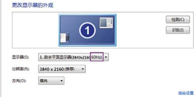
■ 在分辨率设置选项中很容易就能查看到当前的屏幕刷新率
