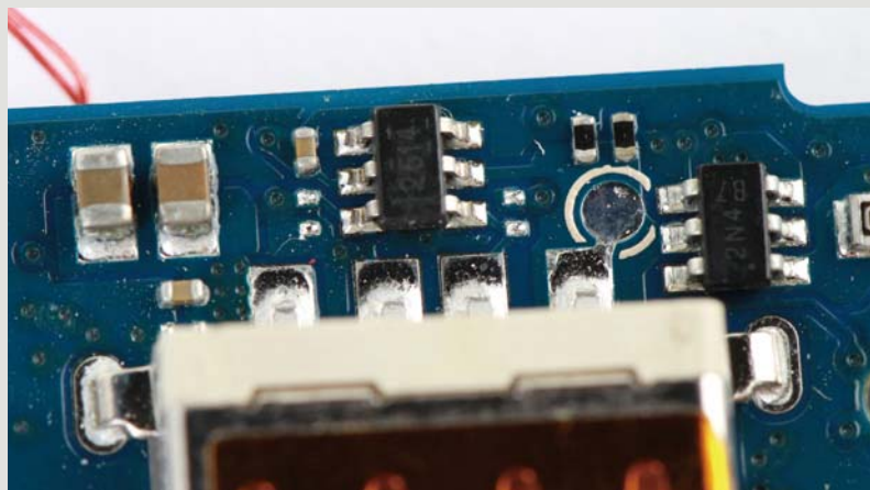
>> HB810搭配的TI TPS2514智能USB端口电压识别芯片, 能够自动识别充电设备并提供最佳充电电流。
