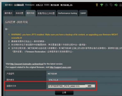
■更新后已经能够支持后缀为.trx的AC68U固件文件,可以自由更新相应版本的AC68U固件文件。
