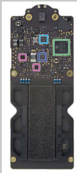
■ 芯片背面是： 绿色：德州仪器TMS320C55超低功耗数字信号处理器 浅蓝：意法半导体AS5C Y523 深蓝：应美盛 ITG-3600三轴陀螺仪 紫色：TI 49C37GI和TI55CHL6I
