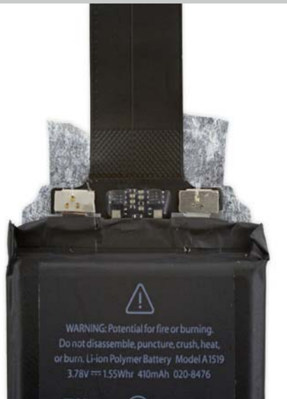
■ 值得一提的是，Apple TV 4th的遥控器电池由之前的可更换的纽扣电池变成了一颗需要充电的410mAh电池，至于是否方便就看用户各自的使用习惯了。
