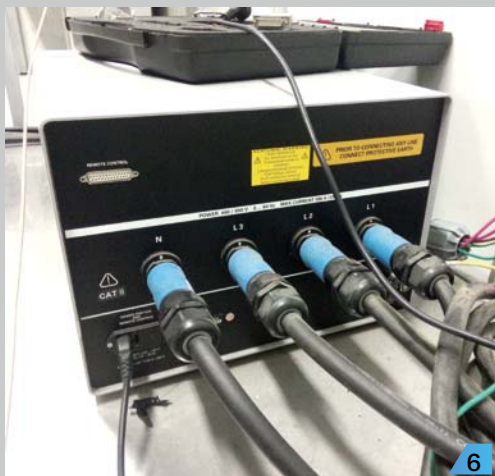
■ 人工电流网络,边上的3口D形线其实就是PC电源与显示器上用的那种,一个电波暗室可能需要测试各种不同功率等级的产品,所以人工电流网络与接线也需要尽量大的功率等级来满足各种需求。
