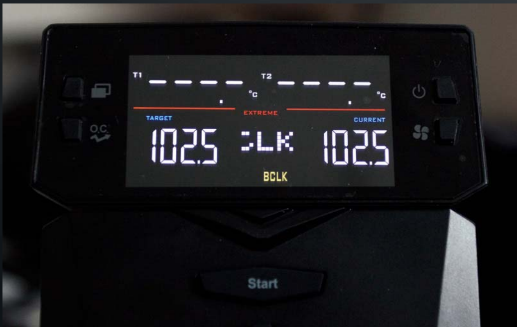
■ OC PANEL II 可在操作系统下实时调节处理器BCLK外频频率、倍频频率与电压的特性,大大方便了超频玩家在操作系统下冲击更高的频率极限。
