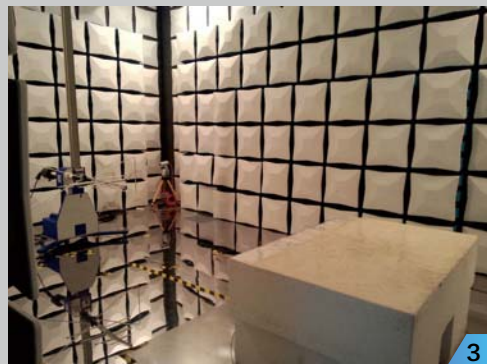
■ 电波暗室测试环境,看起来很简单,实际从材料到设备都不简单。
