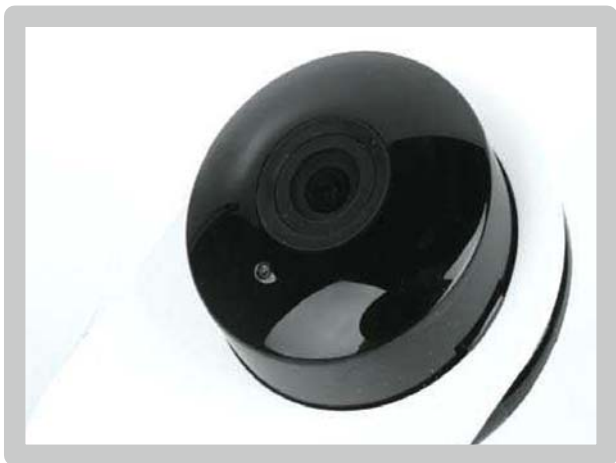
>> 小蚁摄像机的主体为黑色，直径为54mm，通过卡扣固定在白色支架上。
