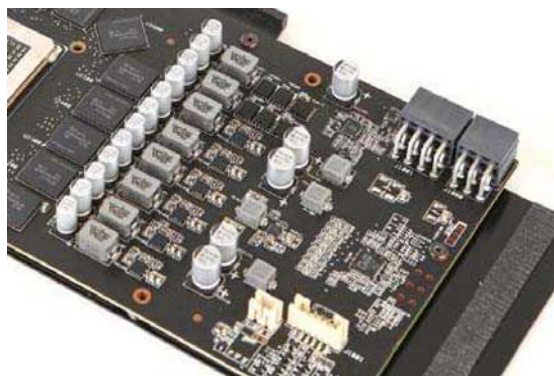
■ STRIX R9 390X采用了6+2+2相供电设计，其中核心供电和显存左上方的辅助供电都使用了合金电感加DrMOS的高品质料件组合。
