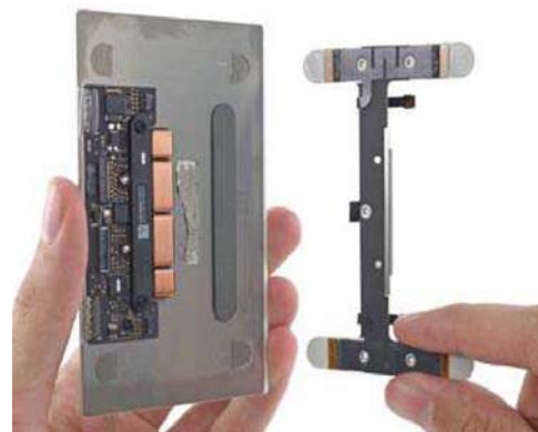
新Macbook搭载的触控板，搭载了压力传感器和Taptic引擎。
