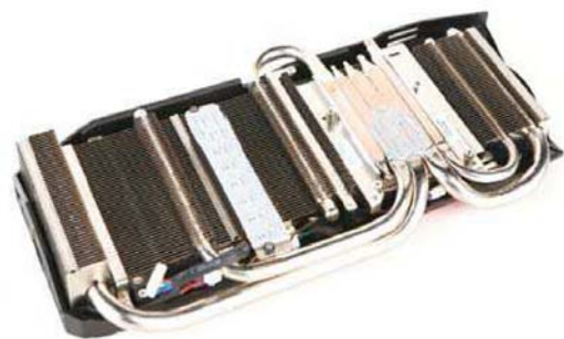
■ STRIX R9 390X的散热系统使用了热管直触设计，多达5根热管配合上大面积鳍片。
