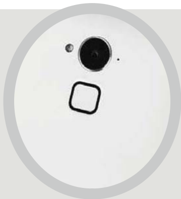
>> 大神Note 3采用了瑞典Fingerprint Cards(FPC)的指纹识别模块，可以提供0.5s的快速指纹解锁。
