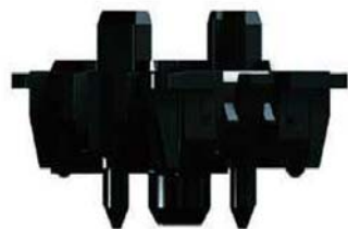
■ 静音轴拆解示意图，其中第二块组件就是新增可降噪的TPE弹性组件。
