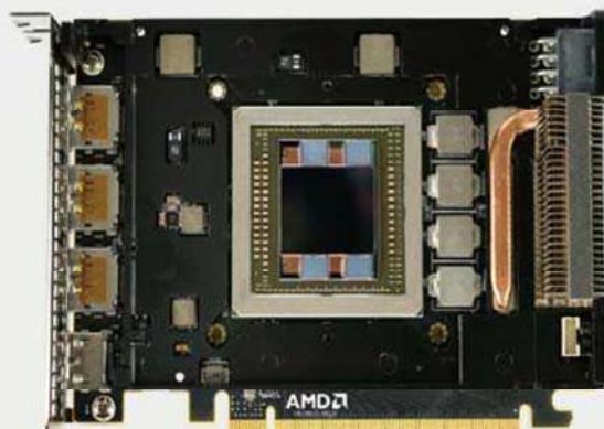
■ R9 Fury nano小小的体积上却设计了两个独立的散热鳍片模块，供电部分带IC控芯片的MOS管有单独的散热鳍片。
