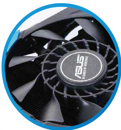
■ 在靠近核心的地方使用了混合动力风扇，融合下压和涡轮两种特性，能兼顾风压与风流面积。
