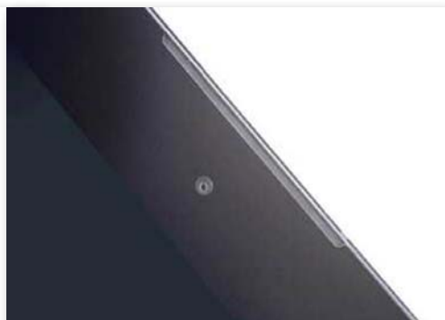
■ 图为 Nexus 9 的网状扬声器, 在正面左右各一个, 组成了立体声系统。
