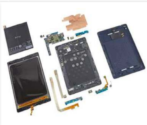
■ 图为 Nexus 9 的拆解图, 做工非常严谨。
