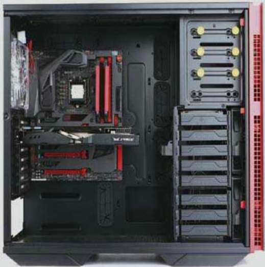
④ In Win 707空间相当宽裕, 安装ATX大板主板加华硕Strix GTX 980这类高端显卡毫无压力, 甚至显得大材小用。
