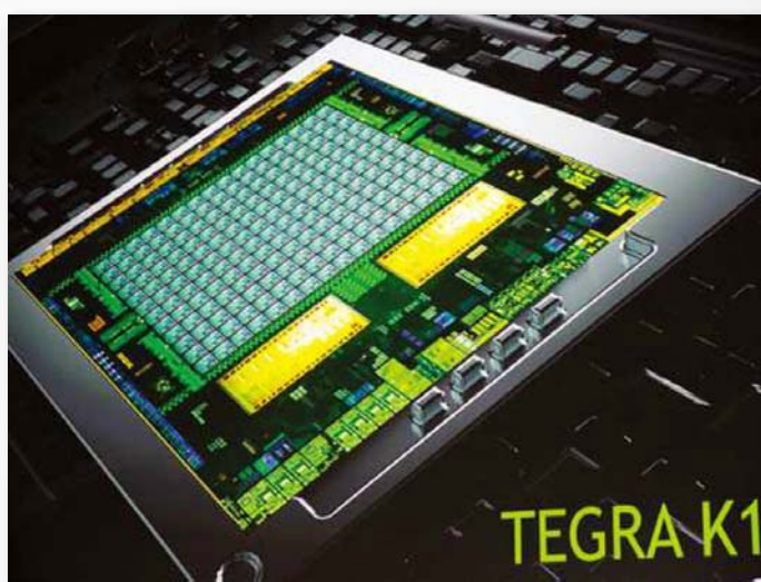
■ Nexus 9最重要的硬件改变就是使用了64位的处理器搭配64位操作系统,其中处理器型号是NVIDIA“Denver”架构的双核版Tegra K1,这也是目前最强的移动处理器之一。
