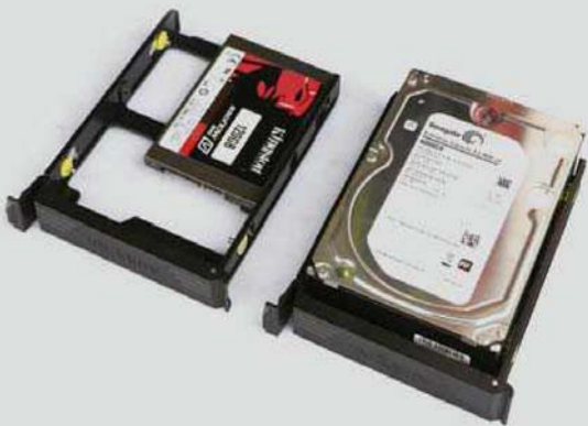
⑥ 硬盘架针对3.5英寸设备设计了免工具扣具; 2.5英寸也能安装, 但需要加拧背部螺丝。
