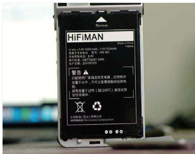
■ 揭开后盖，里面是可拆卸的锂电池，它的下面就是耳放卡槽。
