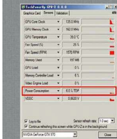
Power Table页信息(上)对应GPU-Z软件“Power Consumption”(左)里的数值, 同时细分了6Pin、8Pin供电和TDP总限制等参数调节。
