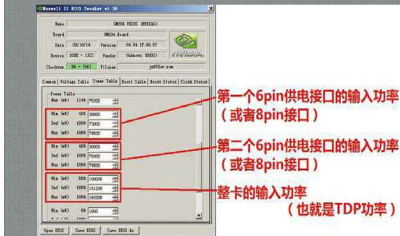
Maxwell II BIOS Tweaker供电宏观调节参数的意义。
