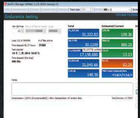
■ 在连续写入55TB数据时，固态硬盘没有出现任何写入错误，剩余寿命侦测还有95%。
