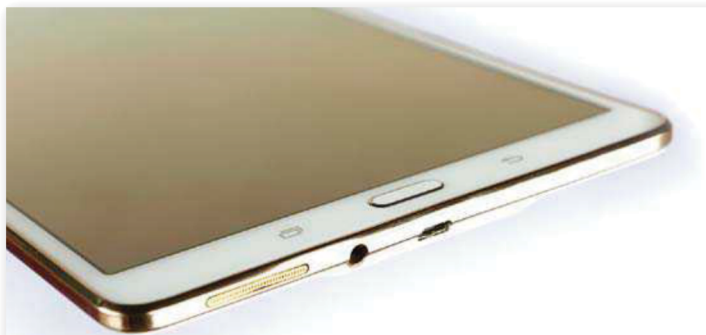
■ 底部除了一个 Micro USB 接口与 3.5mm 耳机接口外, 还有一个网状的扬声器。
