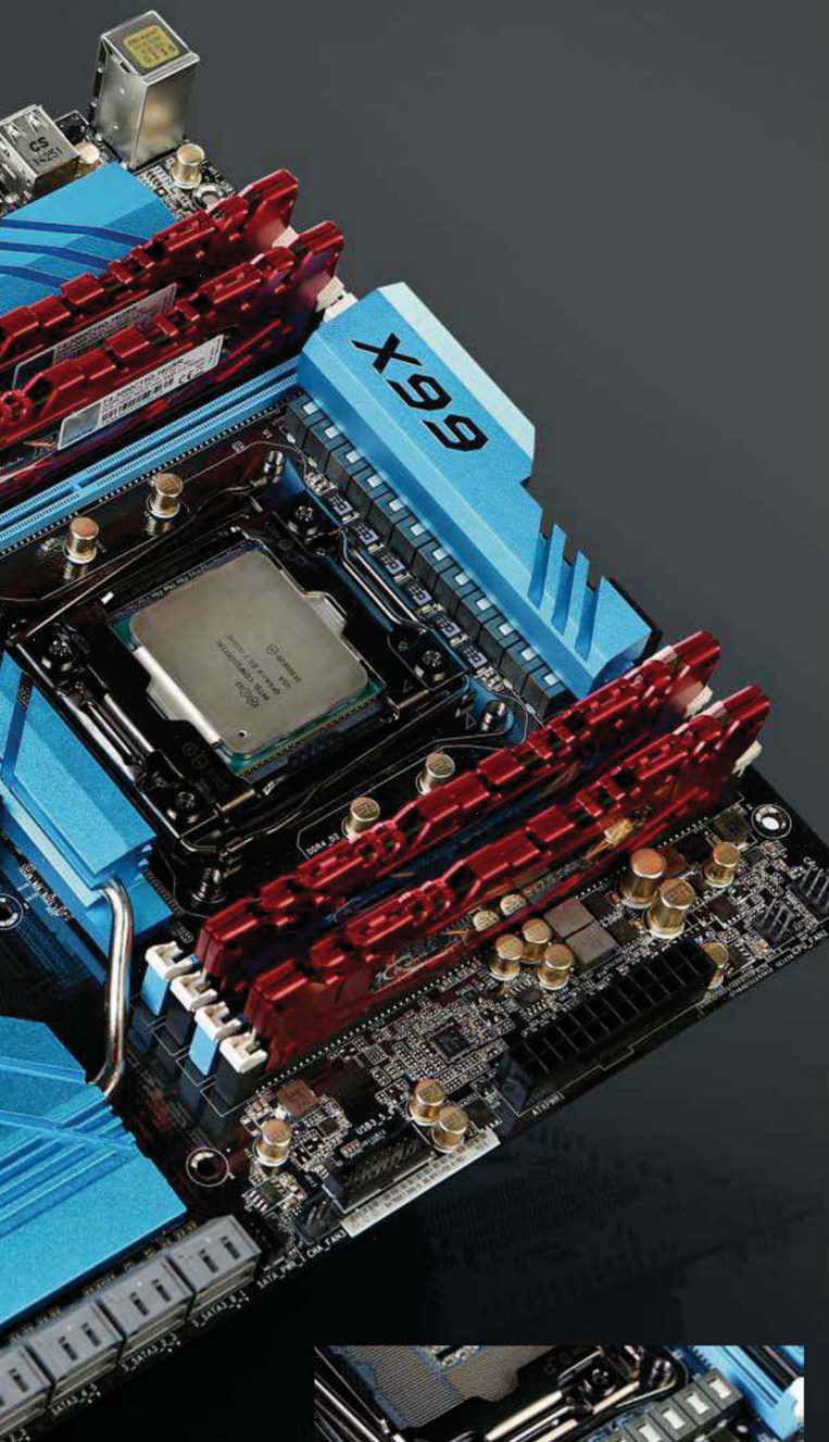
■ 华擎X99WS主板采用豪华的12相供电设计，为8核心处理器进行大幅超频创造了条件。
