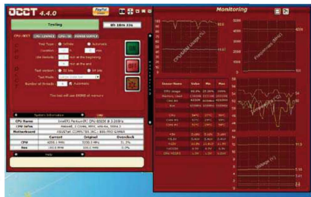
■ Pentium G3258超频至4.2GHz，运行OCCT拷机软件10分钟，记录CPU核心温度。
