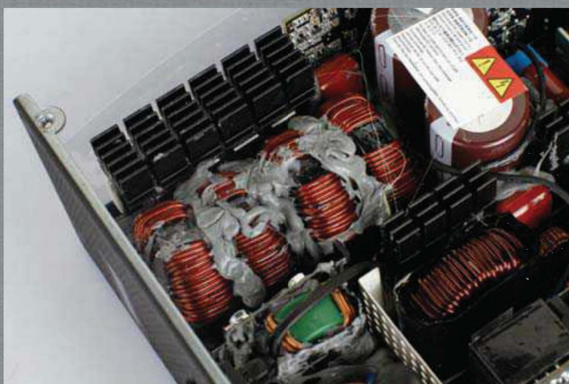
■ 海盗船AX1500i依靠交错式的双路2相无桥PFC产生的PFC高压,以这种不惜成本的方式来满足钛金标准提出的高转换效率需求。
