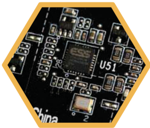
② 除了Realtek的CODEC芯片外,还有一个ESS DAC芯片。
