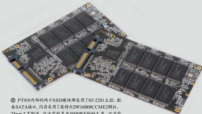
① PT910的PCB结构为三层堆叠式，底层为带PCI-E通信接口的基板，上面为两个SSD模块。
