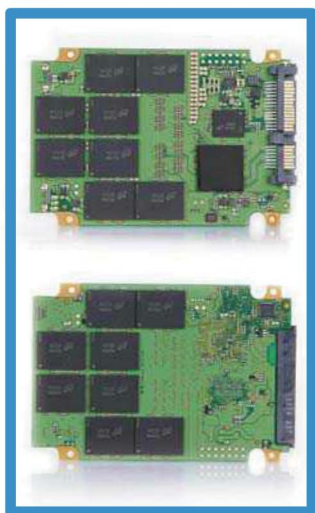
① 总共用了16颗16nm闪存，单颗容量32GB，以及Marvell 88SS9189主控芯片、512MB LPDDR2缓存。
