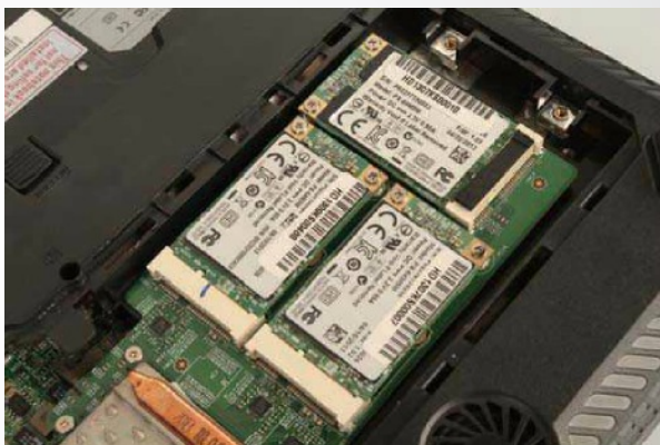
目前有游戏笔记本电脑采用3块SSD组建RAID的方式来提升游戏载入速度, 这在遇到频繁存档读档或者载入素材的情况时改善明显。
