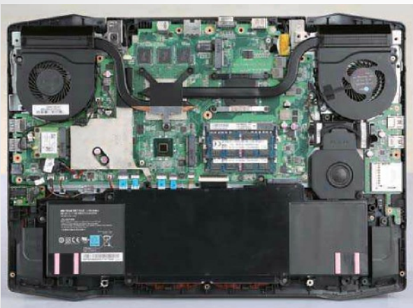
双风扇多热管散热通常出现在中高端机型以及超薄游戏笔记本电脑上。
