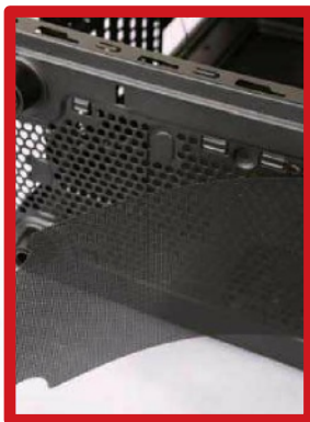
② 机箱顶部和底部均配备有防尘网，如果在前面板处也添加防尘网会更好。
