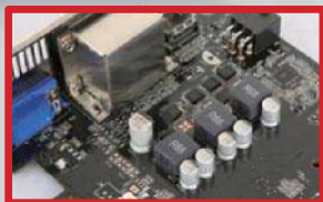
■ 高品质元器件组成的3+1相供电电路
