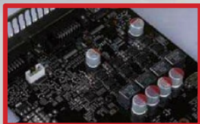
■ 4相核心供电设计用料非常扎实，但输出接口竟然没有采用屏蔽设计。
