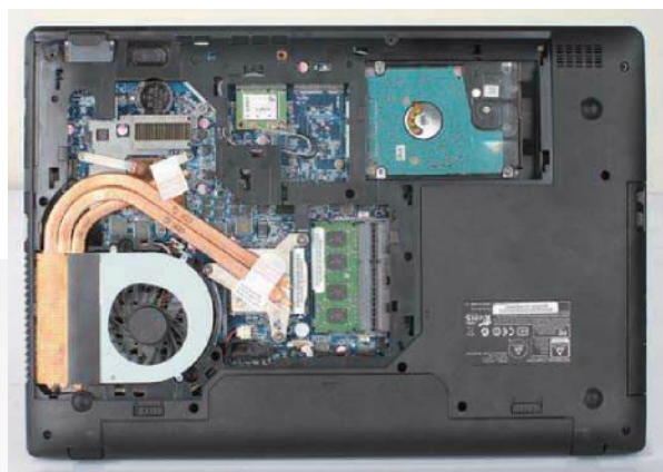
单风扇多热管是目前采用GTX 860M及以下显卡的中低端游戏笔记本电脑常见的散热配置。
