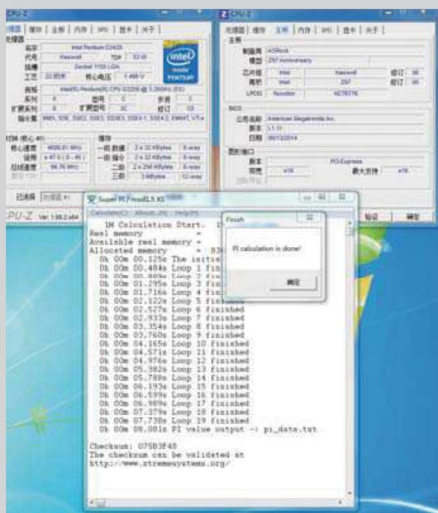
■ 在高性能风冷散热器的帮助下，我们最高可处理频率提升到4.7GHz。
