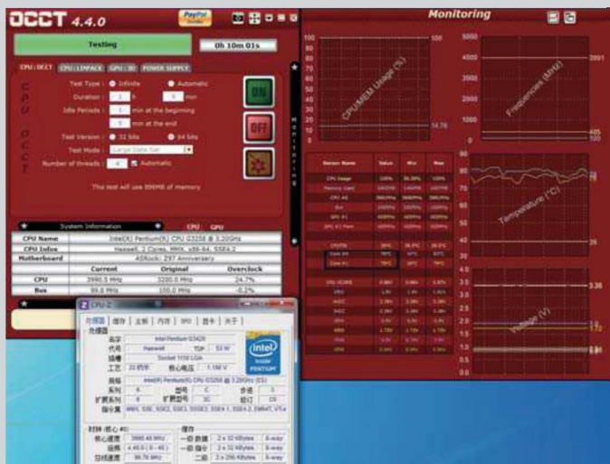
■ 在搭配全铝质的原装风冷散热器时，对奔腾纪念版处理器进行超频后，会带来较大的发热量，因此稳妥起见，建议用户超频到4GHz使用即可。
