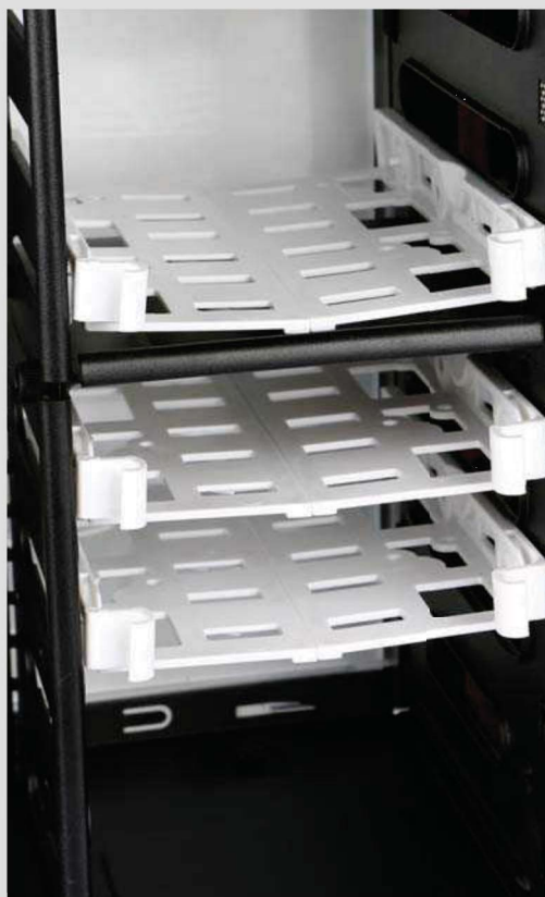
② 它还采用了ABS硬盘架,支持免工具拆装,无需工具就可以拆装硬盘,非常方便。
