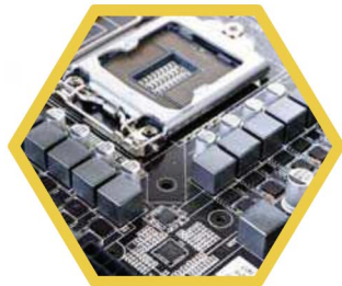
① 采用10相供电电路设计的CPU供电系统
