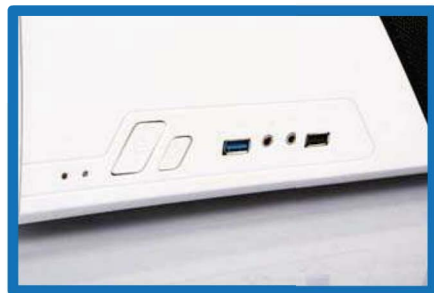
① 开机键、重启键以及USB、音频接口以及指示灯设置在了机箱顶部的右侧，对于经常插拔USB外接设备很方便。
