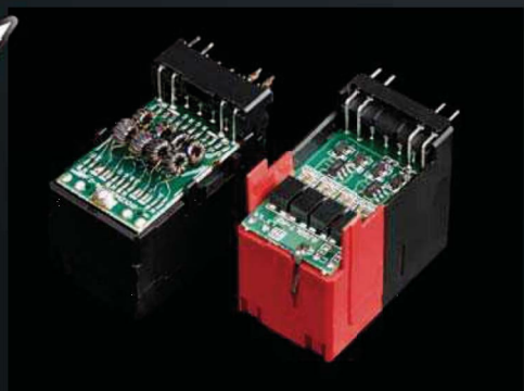
■ 与普通主板上使用的网络接口(左)相比, MAXIMUS VII HERO主板的网络接口(右)加入了ESD静电防护元器件、突波保护元件, 令它具备防雷击、抗静电干扰的特性。
