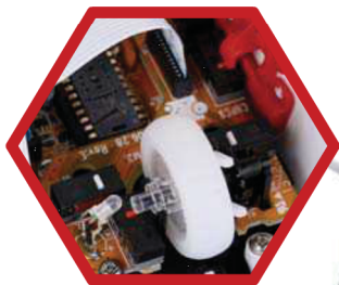
拆解之后可以看到左右两键为定制的华诺白点微动,滚轮和侧键为红点。
