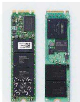
浦科特PX-G256M6e(左),和三星XP941一样为2280规格,不过接口稍有差异,前者少了2个通道的数据金手指。
