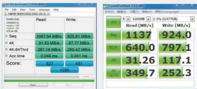
三星PX941加华擎Z97 Extreme 6的M.2系统在AS SSD中获得1230的总评分,在CrystalDiskMark中更是获得了超过1130MB/s的持续读成绩。
