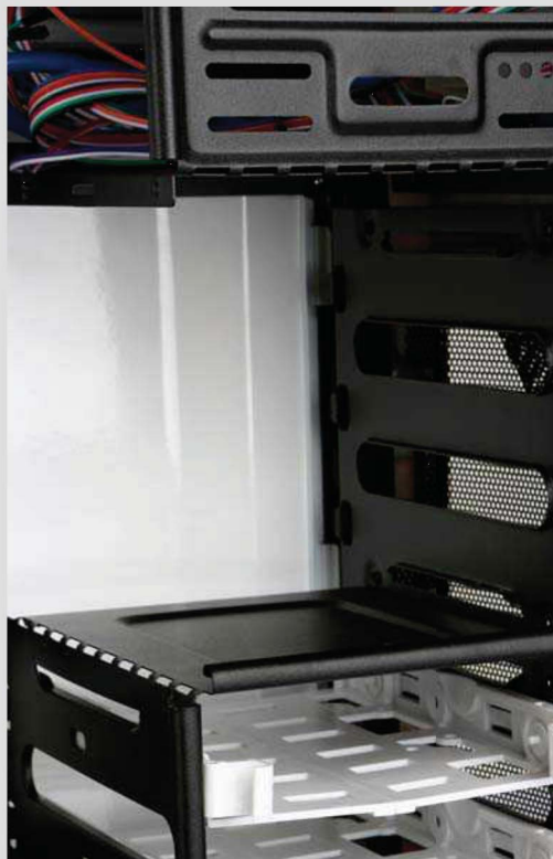
① 在机箱内部,如果需要放置超长显卡,可以拧下位于光驱位下方的硬盘位螺丝,即可把硬盘位挡板拆下,从而扩展显卡的放置空间。
