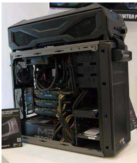
技嘉展台上展示的路GeForce GTX 780Ti SLI水冷系统，机箱上部的空间是水冷系统的核心，针对每路显卡可以监控温度和冷排风扇转速。
