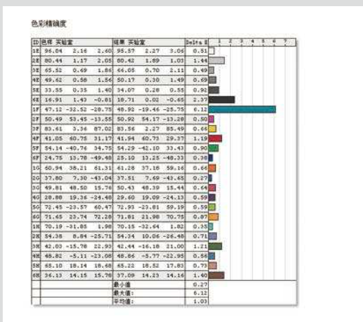
① 飞利浦288P6LJEB的色准图，仅1.03的平均值，在色彩准确性方面的表现很出色。
