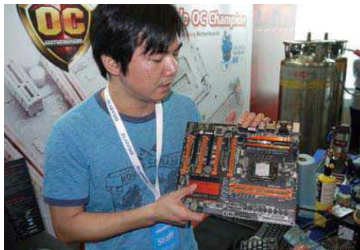
技嘉Hicookie在为记者介绍一款OC系列的新产品GA-Z97X-SOC Force LN2，专为液氮超频设计的主板。和普通主板相比，它是一个另类的存在，处理器插槽附近没有散热器安装孔位，直接使用液氮炮支架。这样的设计可以让处理器通往内存的线路形成直线，保证最好的信号品质。在该主板上，Hicookie刚达成4.5GHz的内存世界纪录。
