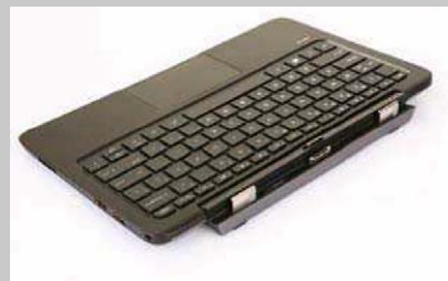
>> 为了提升续航能力, 惠普Pro x2 410 G1在键盘底座中内置了另一块电池。
