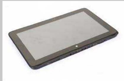
>> 去掉底座的惠普Pro x2 410 G1与平板没什么区别, 扬声器、电源接口、音频接口和存储卡插槽都在机身底部。
