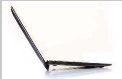
>> 机身连接处外侧凸出, 当惠普Pro x2 410 G1以笔记本电脑形态打开时可以支撑其机身, 使键盘角度更适合使用。
