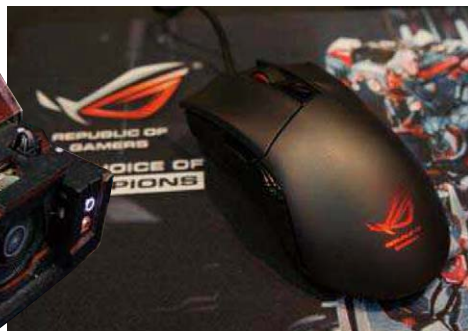
专为第一人称游戏打造的ROG玩家国度Gladius电竞鼠标，它采用流线型人体工学以及防滑橡胶设计。其内置6400dpi的光学传感器，配合鼠标两侧的DPI切换键、自定义功能键可让玩家在各种战场环境下精准杀敌。
