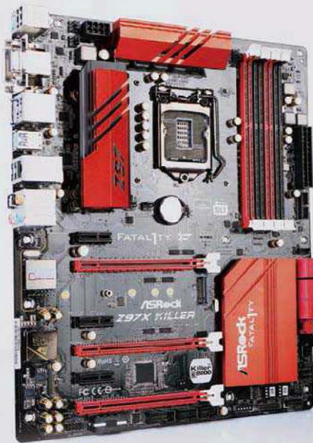
图1:玩家至尊Z97X杀手版主板采用豪华的8相供电设计,并搭配合金电感、双层MOS、12K白金电容等高品质元器件。
