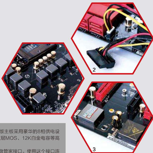
图2:华擎独有的4-Pin硬盘管家接口。使用这个接口连接硬盘的话,用户可以在操作系统中通过软件开启或关闭相应硬盘,达到节能并延长硬盘寿命的目的。
