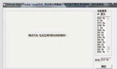
■ 无线模式125Hz下, 相邻的两组数字有着接近1:10的数据差异。
