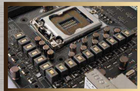
■ 主板采用豪华的16相供电设计，在运行Prime95烤机软件半小时后，供电电路的最高温度点也未超过60℃。
