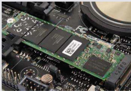
■ PCI-E M.2接口与其相应的固态硬盘在外形上类似于以前的mSATA产品, 非常小巧轻薄, 更适合在HTPC、超极本中使用。
