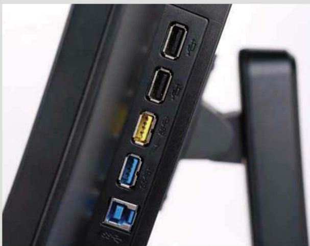
① 显示器左侧是USB接口部分, 提供了USB快速充电接口, 方便为数码设备快速充电。
