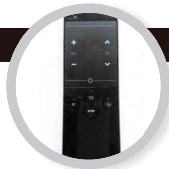
Max70 额外配备了一个体感遥控器,拥有一个小触控板可同时支持触控操作。此外,它的屏显键支持截屏功能,这也给我们的评测带来不小的方便。
