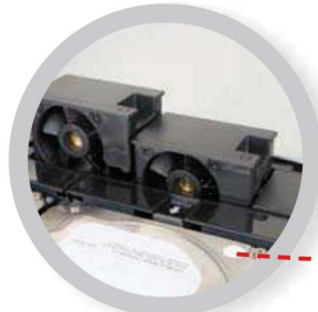
在机身中部设置了三个可拆卸式风扇。
