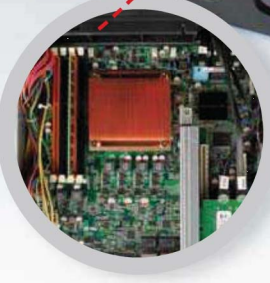
主板搭载了全固态电容、散热铜块DIMM ECC内存，内部做工扎实。
