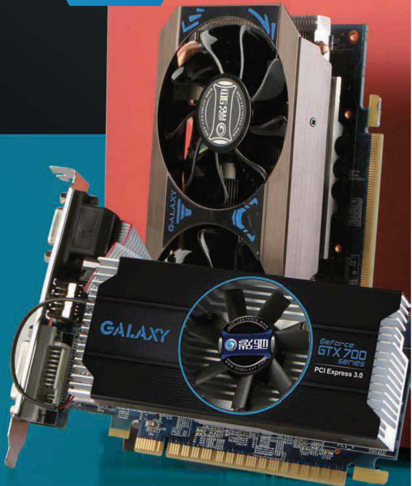
■ 影驰GTX760Mini的接口部分双DVI占用了较大面积,因此在HDMI和DP接口的上方,影驰设计了高镂空率的通风口。
