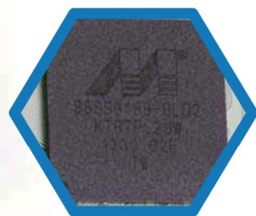
① 硬盘采用在频率、功能上有小幅提升的Marvell 88SS9189主控，性能更好。
