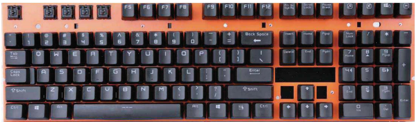
■ 在键盘的内部，雷柏为其设计了一块非常有特色的橙色钢板，在很多时候这块钢板甚至营造出了背光的效果。为机械键盘增加钢板的设计也基本是此类中高端产品的通用设计。
