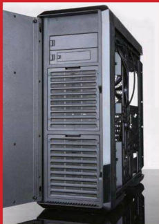
■ 对开门侧板还设计了钥匙加底座扣合按钮的双重保险开关。左侧板设计为对开门，前半块较小，刚好能覆盖硬盘托架，后半块则为大面积开面设计，能让玩家透视整个板卡安装区域。
