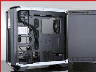
■ 4个2.5英寸硬盘位全部隐藏在右侧板内,采用竖立放置方式。
