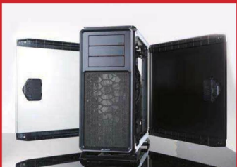
■ 车门式的侧板开合设计,左侧板几乎全透,搭配上下两白色金属加固条,有DIYer戏称此为“HTC”风格。
