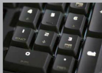
■ 由于轴体的遮挡，光线不均匀，键帽下部分镂空字样的漏光几乎没有。
