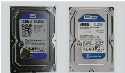
■ 外观上WD5000AZLX和WD5000AAKX没有太大区别,容量也一样,用户们需要仔细分辨S/N标号。
