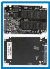
② 影驰虎将500 512GB SSD内部结构，由8颗闪存颗粒、一颗SM2246EN主控芯片，以及一颗512MB缓存颗粒组成。
