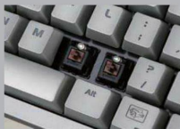
■ 传统MX轴使用直插式LED，安装位在轴体上方。
