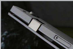
ThinkPad 轻薄机型已经逐渐采用这种下沉式转轴，它的优点在于可以使机身做的更加薄，同时ThinkPad 将它进行了优化，能够实现 180°开合。
