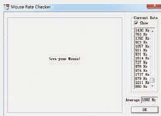
■ 使用Mouse Rate Checker来测试鼠标不同回报率下的工作稳定性
