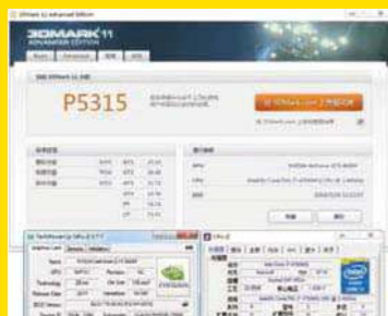
■ GM107核心的GeForce GTX860M在3DMark 11中得分达到了P5315。
