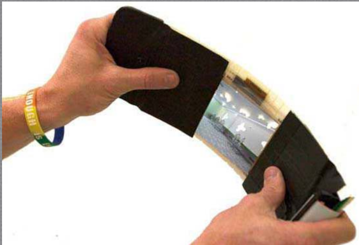
■ 采用柔性OLED屏幕+多摄像头 的FlexCam概念全景相机
