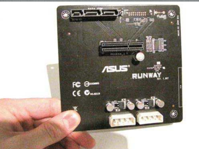
■ 略显粗糙的SATAe转PCI-E工程转接板, 由于目前还没有任何SATAe设备, 因此只能通过连接PCI-E SSD来测试SATAe的接口性能。
