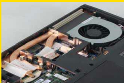
■ 考虑到整机功耗不算太高,单热管单风扇的散热设计也算比较靠谱。
