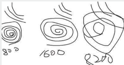
■ 采用画圆的“土”方法来参考测试鼠标在不同CPI/回报率设置下的工作稳定性，主要看再不同CPI设置下，鼠标在画圆的过程中，线条是否有明显的毛刺及抖动出现。
