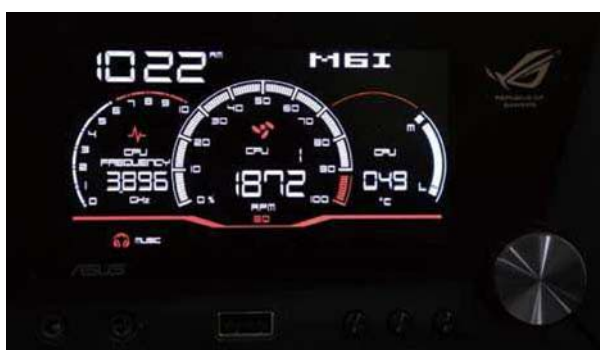
② 旋转按钮，我们即可轻松将风扇转速调节至最高，有效降低处理器温度。
