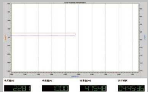
■ 使实际输出电能为23.6Wh (4755mAh×4.96V)
