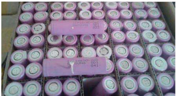
■ 图为经过专业翻新的二手电芯, 仅仅只从外观很难进行区分。但细看的话还是可以看到部分电芯上有重复的焊点、明显的锈斑或是明显的打磨痕迹。
