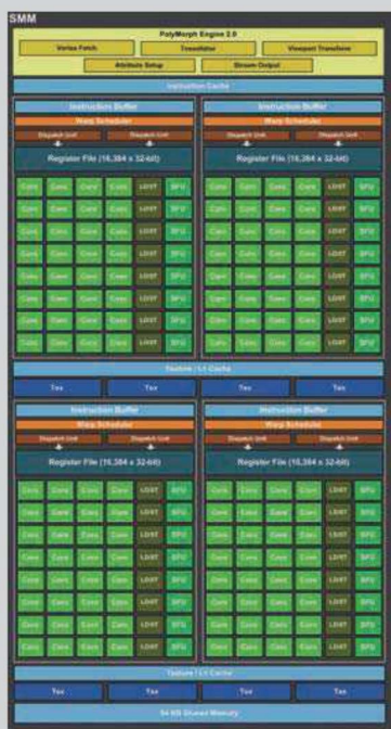
国外网站Anandtech以更为明朗的方式对比了Maxwell（左）和Kepler（右）的架构图。用个不算太恰当的比喻来说，如果Maxwell的SMM是“小而精”的话，Kepler的SMX就是“傻而大”。
