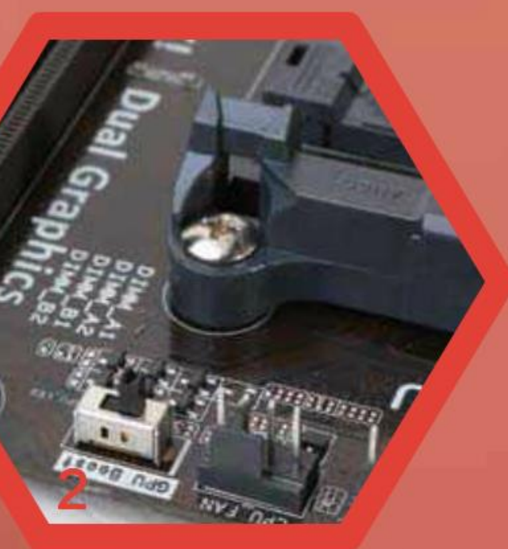
1.在供电电路部分,A88X-PLUS采用了较为传统的4+2相设计,足以满足Kaveri APU的一切应用需求。 2.亲,GPU BOOST开关。利用这个开关,可以为Kaveri APU的融合显示核心提速。
