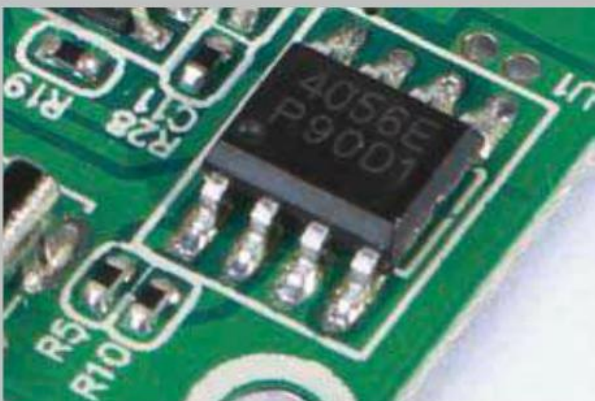
■ 使用了两块聚合物电芯并联, 采用了比较廉价的PCB方案, 使用的充电IC为国产芯片。
