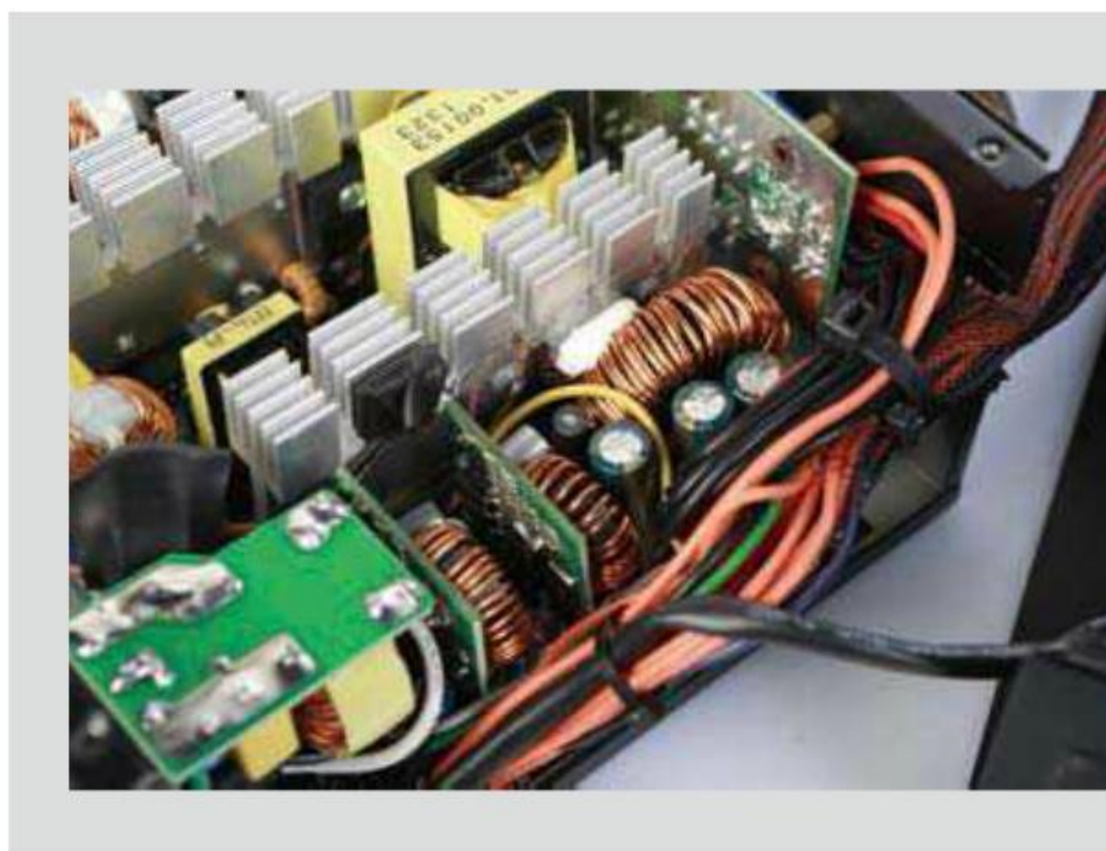
金牌产品上的常客——DC-DC模块设计,能有效提高输出端的效率。
