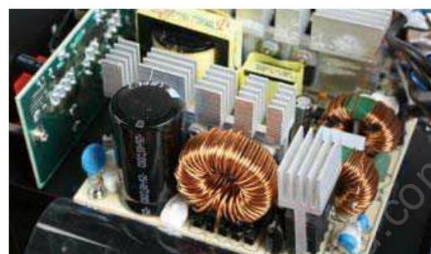
■ 航嘉MVP500PFC电感做工和用料扎实, 主电容采用的是耐压值450V、容量330μF的型号, 冗余丰富。而这也是它能提供宽幅和稳定特性的基本保证。
