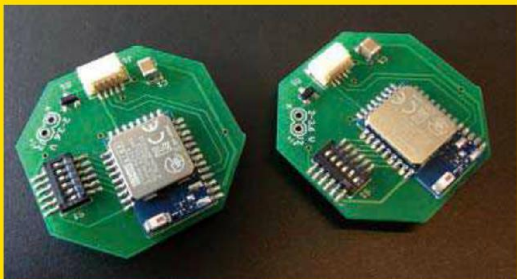
■ iBeacon基站内部一览。
