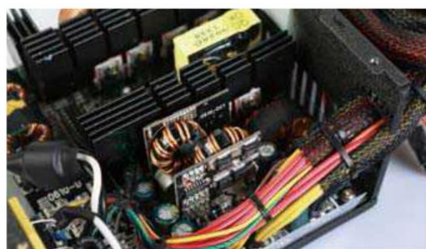
■ GP600G后级电路采用了同步整流和DC-DC模块电路设计, 这通常出现在高定位的产品中。对一款不到300元的电源而言, 显得难能可贵。
