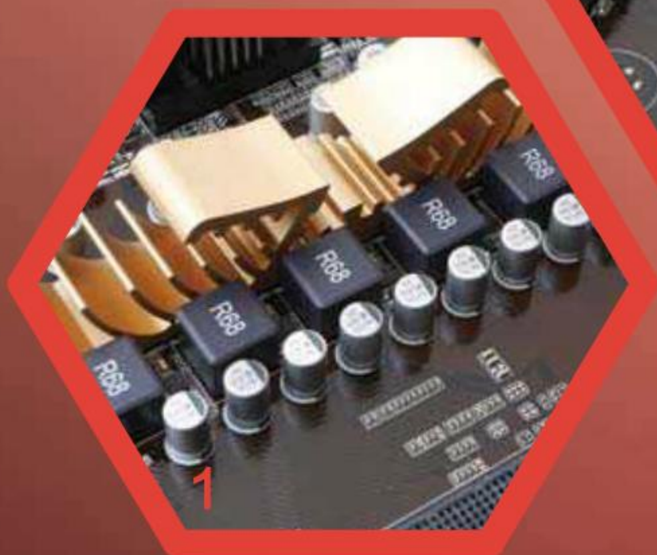
1.在供电电路部分,A88X-PLUS采用了较为传统的4+2相设计,足以满足Kaveri APU的一切应用需求。 2.亲,GPU BOOST开关。利用这个开关,可以为Kaveri APU的融合显示核心提速。
