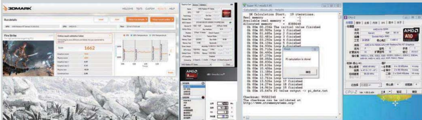
■ 对于普通用户来说，更为实用的是进行CPU核心与整合图形核心的双双小幅超频，从而获得娱乐性能上的提升。 ■ 如单单仅对CPU核心频率超频，那么APU频率可以在风冷环境下实现4.7GHz的高频，将Super Pi一百万位测试时间缩短至15.647s。
