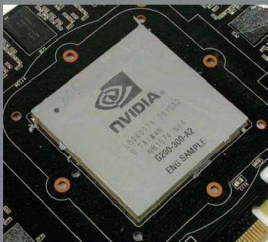
■ 史上最大核心65nm版本的GT200封装，NVIDIA首次触碰到了600平方毫米的“红线”。从此之后数代，NVIDIA都尽量将GPU面积控制在550平方毫米以下。
