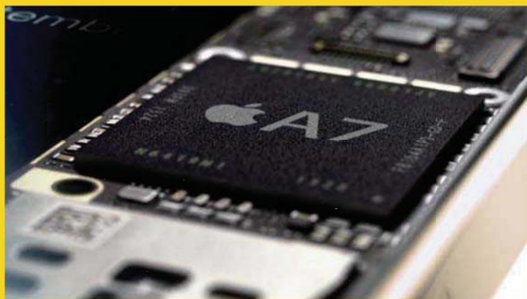
■ 苹果在iPhone 5S上使用的A7处理器，是业界首款64位ARM处理器。
