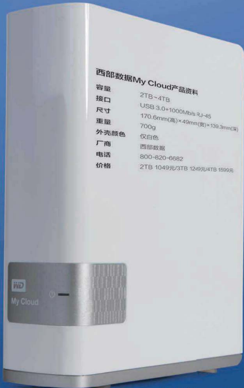
■ 整体外观以白色为主,辅以银灰装饰,前面板非常简洁,除了LOGO和一个蓝色的LED指示灯再无它物。
