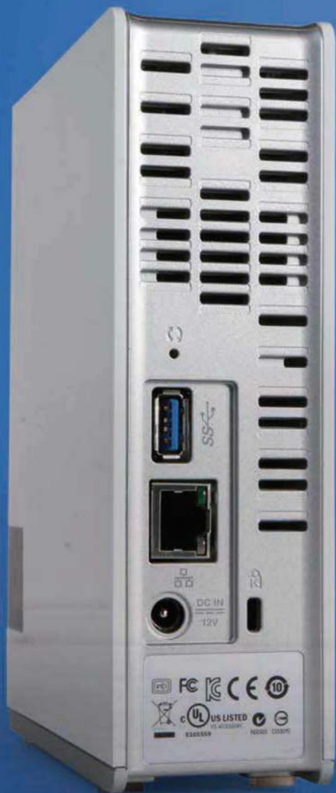
■ 接口设计简洁、实用,千兆有线网络满足网络分享绰绰有余,USB 3.0则能为移动设备直连提供充足数据带宽。
