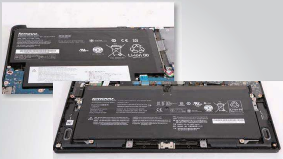
Yoga2 Pro13 配备了 54Wh 规格电池,ThinkPad S1 Yoga 则配备了 47Wh 电池规格。通过 Powermark 测试,两款机型的续航时间都可以达到 8 小时左右,在变形本中都属于十分优秀的水准。
