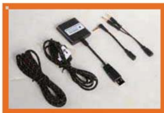
① 附件提供了支持杜比音效的USB声卡，以及为满足各种平台的连接线。
