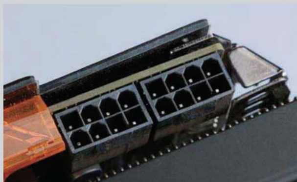
■ 1100MHz (1150MHz)/6400MHz的超高频率使得该显卡需要双8Pin的外接供电
