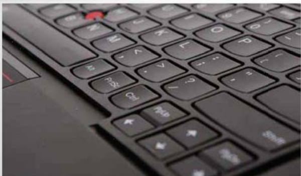
升降式键盘对于提升使用体验和保护键盘确实有所帮助，同时相比 Yoga2 Pro13，ThinkPad S1 Yoga 额外拥有小红帽指点杆，操作方式多样，易用性无需多言。
